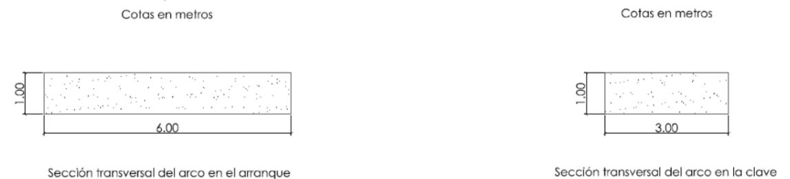
La sección transversal es maciza ya que lo ajustado de los cantos utilizados no aconsejan plantear aligeramientos. El empleo de una sección maciza de estas dimensiones proporciona un más que correcto funcionamiento de la estructura propuesta.
