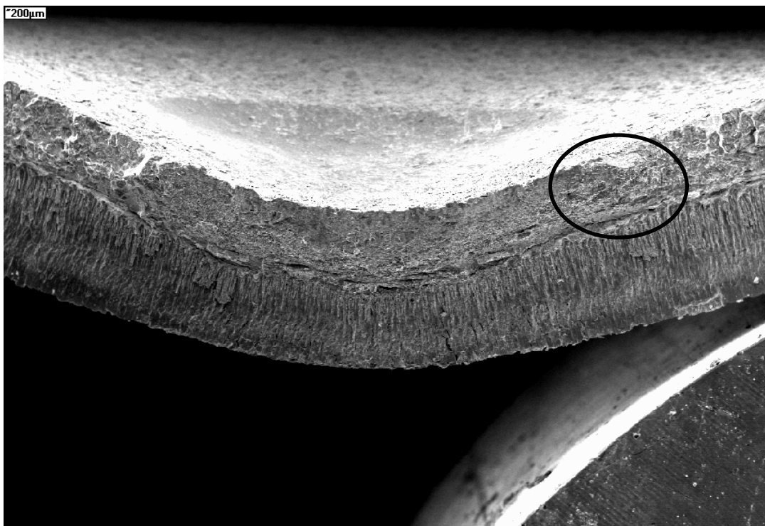
Figura 5.12. Zona central de la fisura en la probeta SPT0.5-04 (35X).
