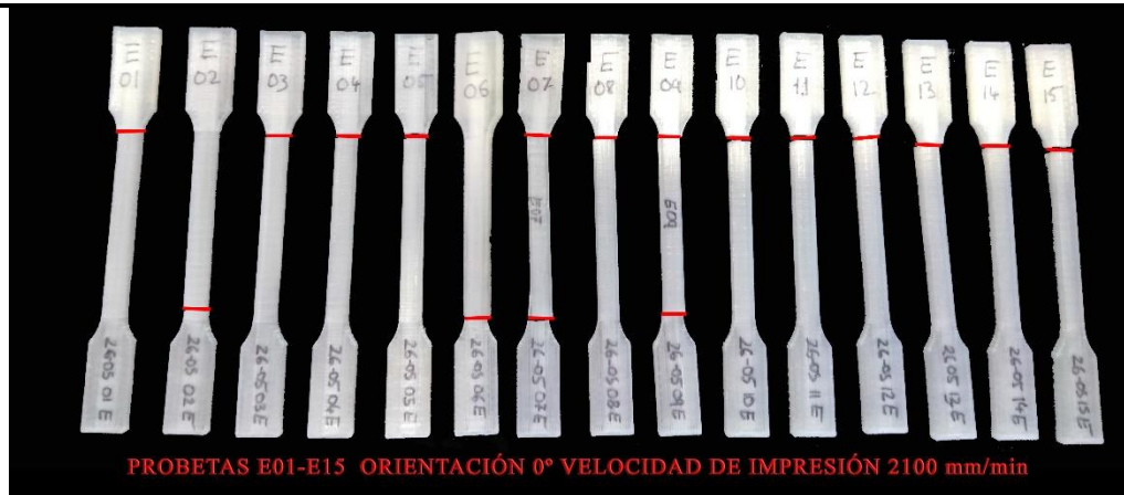
Figura 58 Probetas E01-E015 tras ser ensayadas. En rojo se ha señalado la fractura
