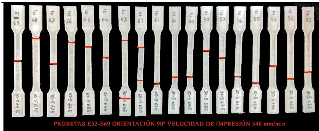
Figura 61 Probetas E52-E69 tras ser ensayadas. En rojo se ha señalado la fractura
