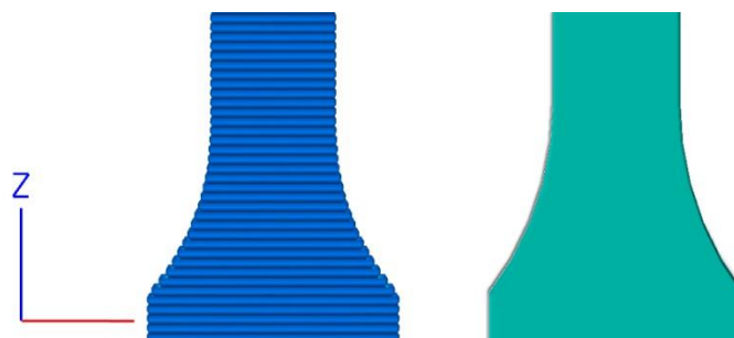
Figura 5 Aproximación a la curvatura en la dirección Z mediante capas, conocido como efecto escalera.
