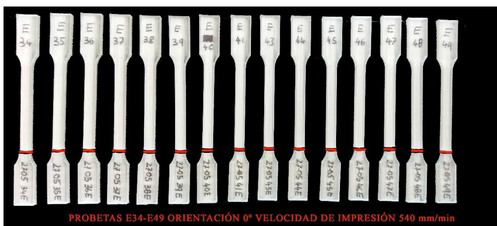
Figura 60 Probetas E34-E49 tras ser ensayadas. En rojo se ha señalado la fractura
