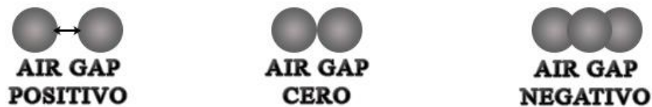
Figura 1 Tipología de air gap (espacio entre filamentos adyacentes). Elaboración propia
