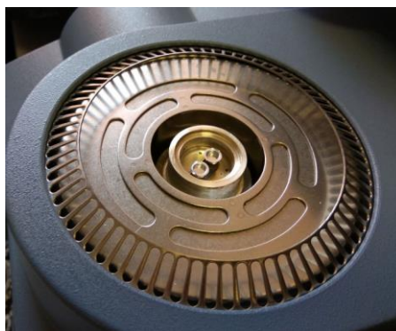
Figura 31 Colocación de muestra y comparación dentro del DSC
