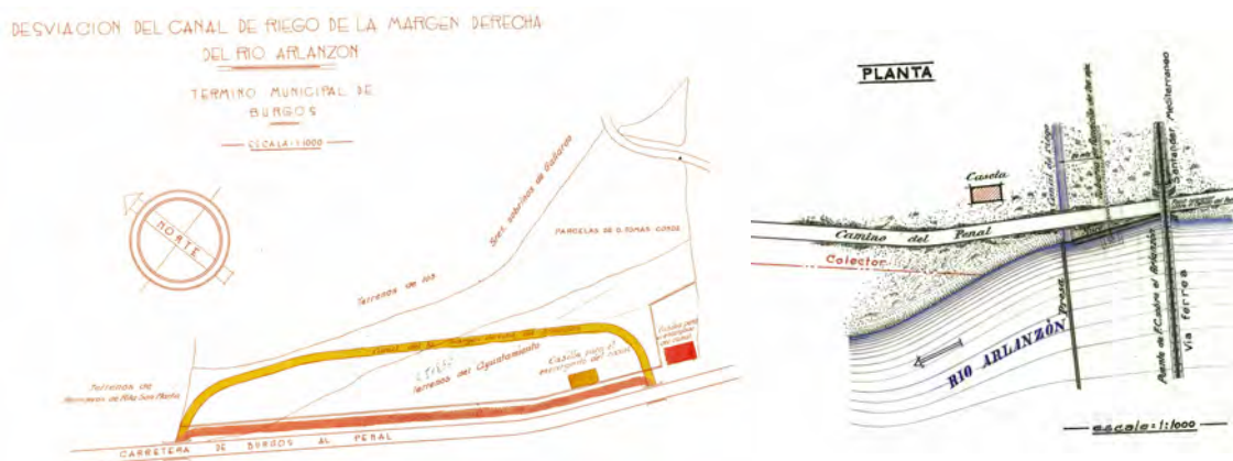
Ilustración 19. Dibujos representativos del canal de riego y de su desviación prevista, así como de la toma de agua para la Fábrica de Papel
