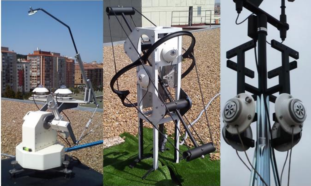
Figura 2.10: Subestación radiométrica. Izquierda: seguidor solar. Centro: difusa vertical MK6. Derecha: Global vertical.
