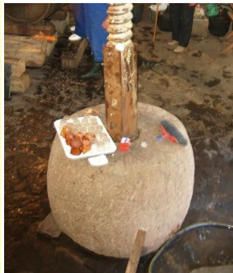
Lámina 52: A. Antiguos “poyos” de jaraíz situados en distintos rincones de la villa 1282 . B. Esquema de un lagar 1283 . C. Poyo o pilón de lagar en bodega 1284 .
