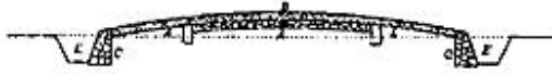
Fig. 13. Camino de la segunda mitad del siglo XVIII en España. A = Tierra hombrada y piconeada. B = Empedrado a mano y golpe. C = Estribas de mampostería en seco. D = Capa de grava. E = Fosas para el desagüe.
