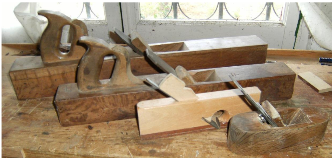
Fig. 111: Garlopa, garlopín, guillamen y cepillo; cajas de encina y cuñas de haya. Herramientas de D. Fernando Labrador. Agosto 2.014.
