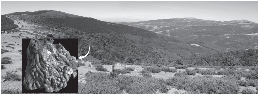
Fig. 5. Escorial situado en el paraje Mina del Rey, recorrido por el arroyo de Las Herrerías (Riocavado de la Sierra), en la vertiente nororiental de la Sierra de Mencila. En las escorias se aprecian las características estructuras de flujo debidas al sangrado de los hornos de reducción.
