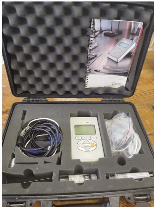
Figura 44. Equipo KD2 Pro Thermal Properties Analyzer, de Decagon Devices, Inc., ubicado en la Universitat de Barcelona (UB).
