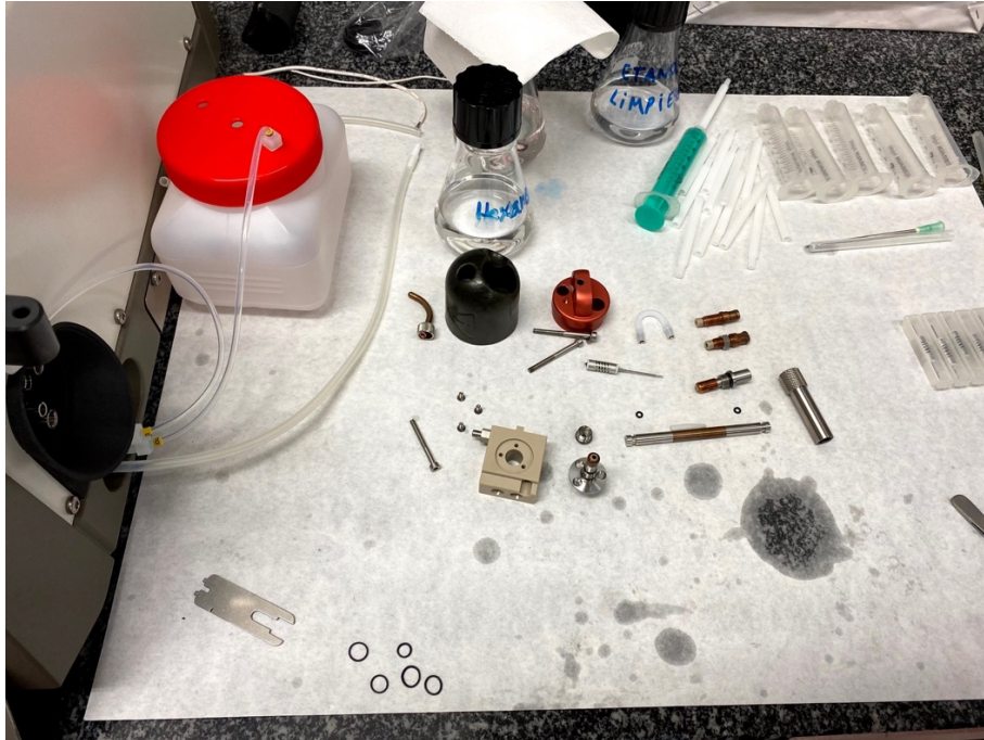
Figura 6. Despiece de la celda de medida y el hot filling attachment del viscosímetro Stabinger.
