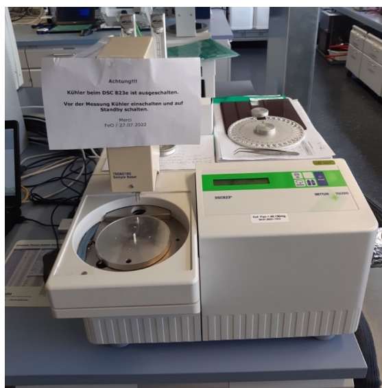
Figura 26. Equipo DSC823e de Mettler Toledo ubicado en la Hochschule Luzern (HSLU).
