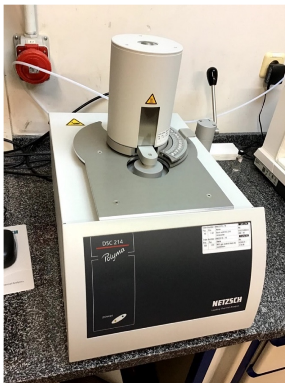
Figura 25. Equipo DSC 214 Polyma de NETZSCH ubicado en la Universidad de Burgos (UBU).
