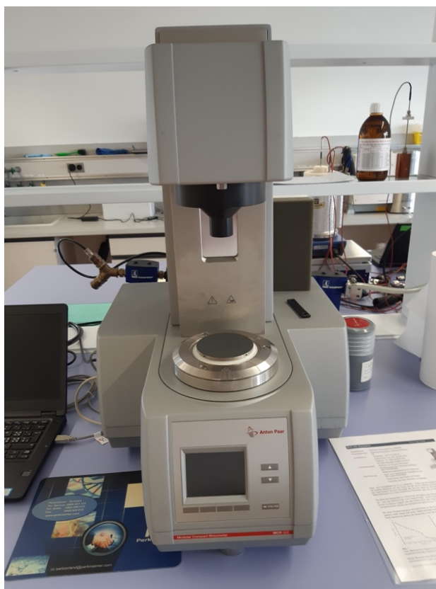
Figura 7. Equipo MCR 302e de Anton Paar de la Hochschule Luzern (HSLU)
