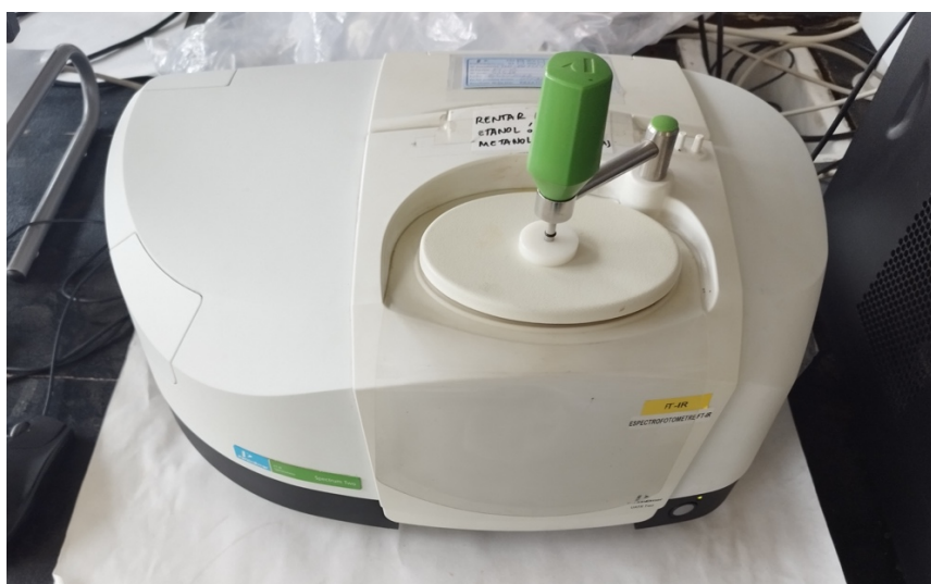
Figura 48. Equipo FTIR Spectrum Two™, de Perkin Elmer, ubicado en la Universitat de Barcelona.
