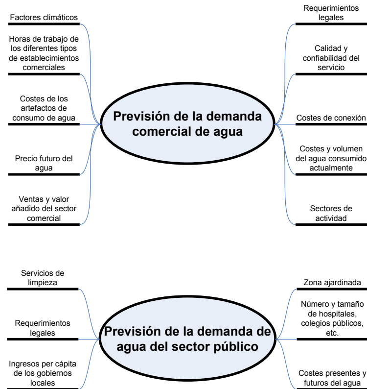
Figura 4. Diagrama de los principales factores de influencia en otros componentes de la demanda urbana de agua. A partir de ADB (1999)
