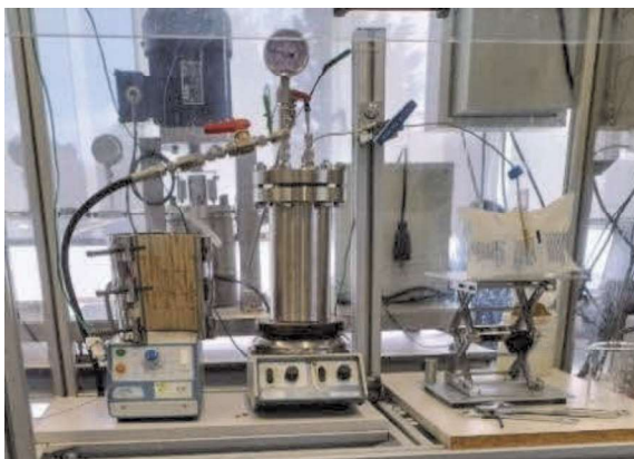
Figura 4. Fotografía del equipo de extracción con agua subcrítica utilizado para la obtención del hidrolizado de triturado de piel de cebolla.
