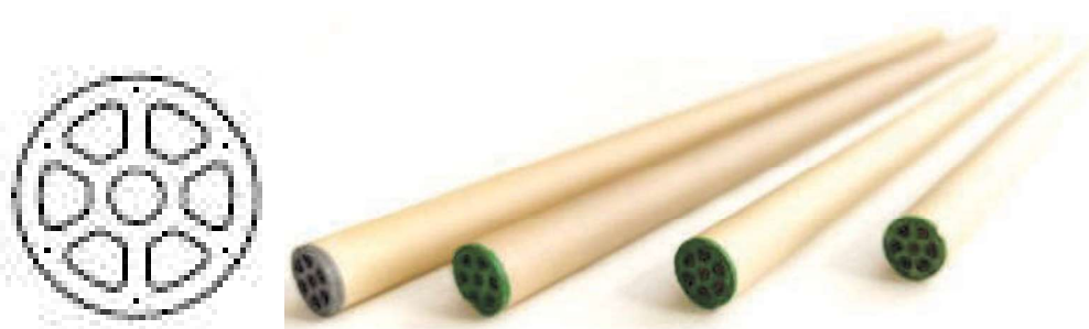
Figura 6. Fotografía de las membranas cerámicas de TiO 2 multicanal (7 canales) empleadas en los experimentos de UF y DF realizados durante este trabajo.
