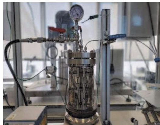
Figura 4. Fotografía del equipo de extracción con agua subcrítica utilizado para la obtención del hidrolizado de triturado de piel de cebolla.
