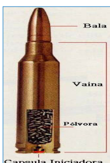
Figura 2: Partes de un cartucho
