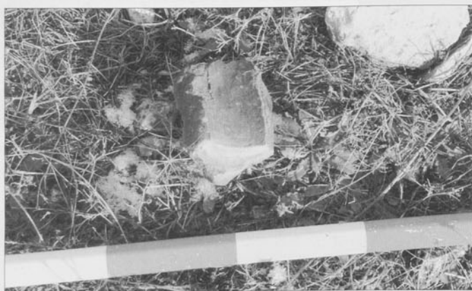
Trozo de tubería moderna con el interior vitrificado, procedente de la traída de aguas desde el Arca a la fuente de la Cambija
