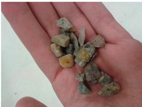
**Figura 1.** Árido de hormigón reciclado.
