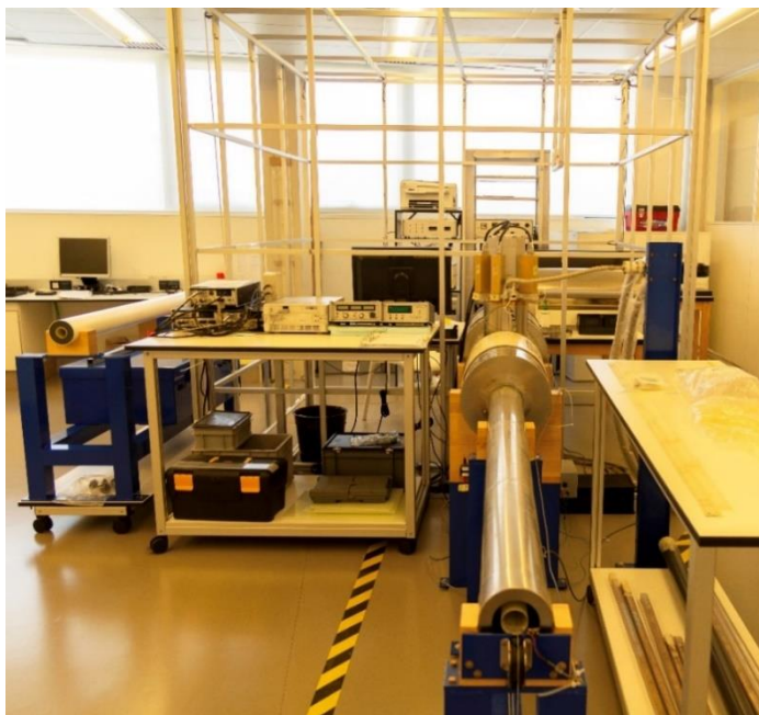
Figura 4.28. Magnetómetro criogénico (SQUID) (755 SRM, 2G Enterprises). Imagen del archivo fotográfico del CENIEH.
