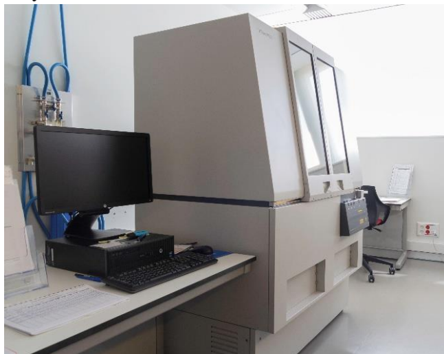
Figura 4.31. Difractómetro de rayos X PANalytical X'Pert PRO. Imagen del archivo fotográfico del CENIEH.
