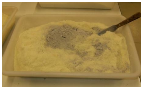
Imagen 7.7. Mezcla de residuo de espuma de poliuretano blanco y yeso
