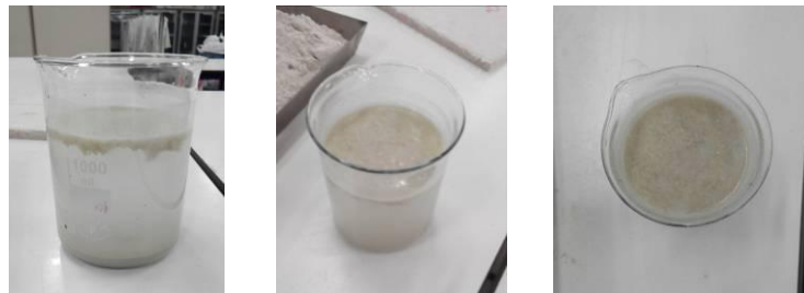
Imagen 10.5. Eliminación del residuo por flotación (yeso+residuo)
