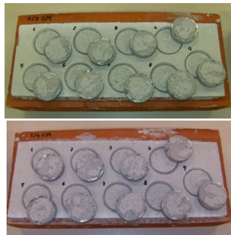
Imagen 6.3. Ensayo de adherencia 1/3 GM y 1/4 GM
