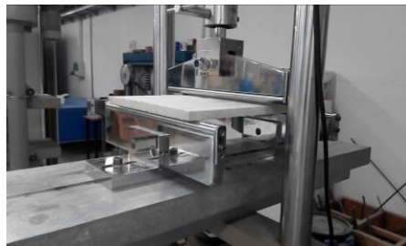
Imagen 10.14. Ensayo de carga de rotura a flexión
