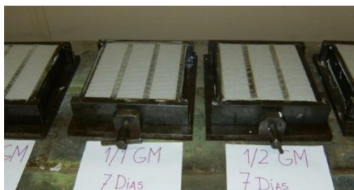
Imagen 6.1. Fabricación de probetas (40x40x160) \text{mm}^3
