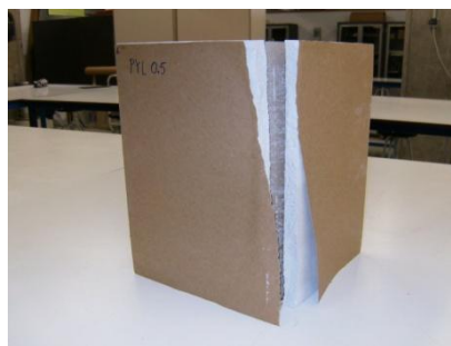
Imagen 7.13. Probeta con papel: fallo por adhesión del papel
