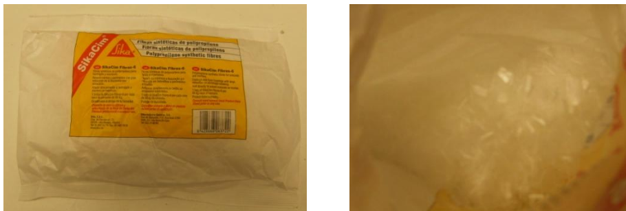
Imagen 5.18. Fibras de polipropileno SikaCim® (F1)
