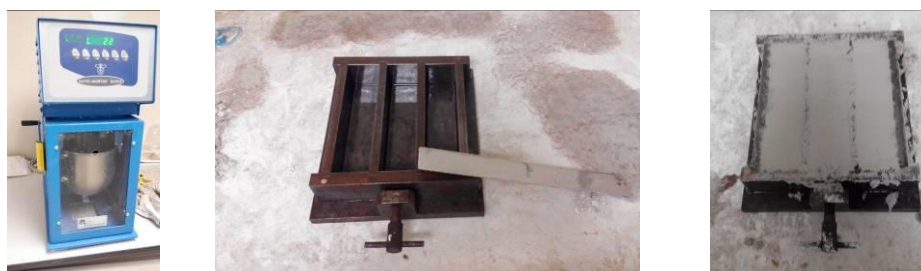
Imagen 10.9. Fabricación de probetas de (40x40x160) mm 3
