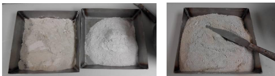
Imagen 10.8. Basanita - yeso B1. Mezcla de ambos materiales
