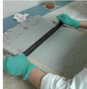
Imagen 7.8. Amasado manual de la mezcla Imagen 7.9. Llenado del molde
