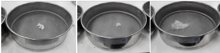
Imagen 10.4. Retenido en los tamices de 4, 2 y 1mm
