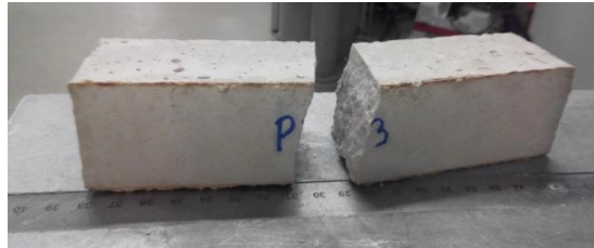
Imagen 10.10. Probeta de (40x40x160) mm 3 rota en el ensayo de flexión
