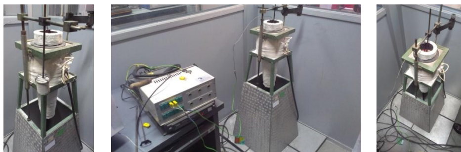
Imagen 7.17. Equipo utilizado en el ensayo de reacción al fuego de productos
