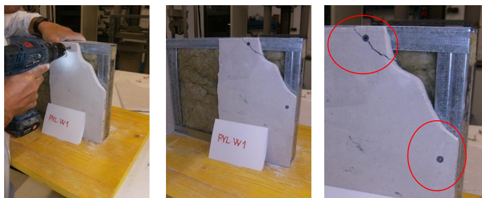
Imagen 9.3. Detalle rotura placa PYL W1
