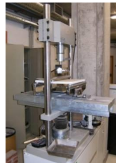
Imagen 4.22. Dispositivo de carga y ordenador que lo controla.
