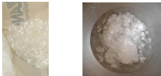
Imagen 8.1. Fibras agregadas al agua de amasar
