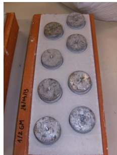
Imagen 4.16. Ensayo de adherencia
