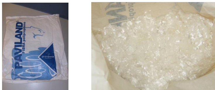
Imagen 5.19. Fibras de polipropileno Paviland® (F2).
