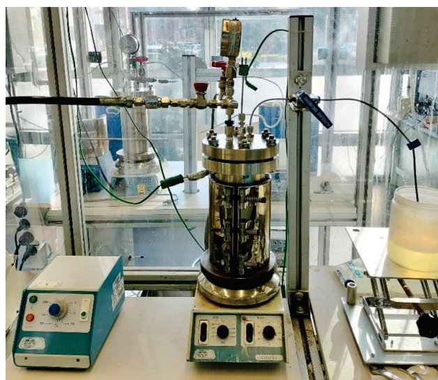
Figura 4. Fotografía del equipo de extracción utilizado en este trabajo para la hidrólisis con agua subcrítica.
