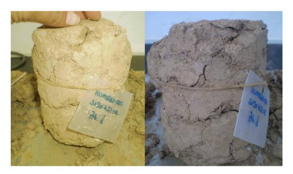
Figura 165. Probetas tras ensayo humedad-sequedad de la mezcla S1C2
