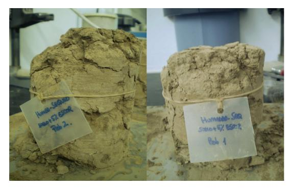
Figura 166. Probetas tras ensayo humedad-sequedad de la mezcla S1E5
