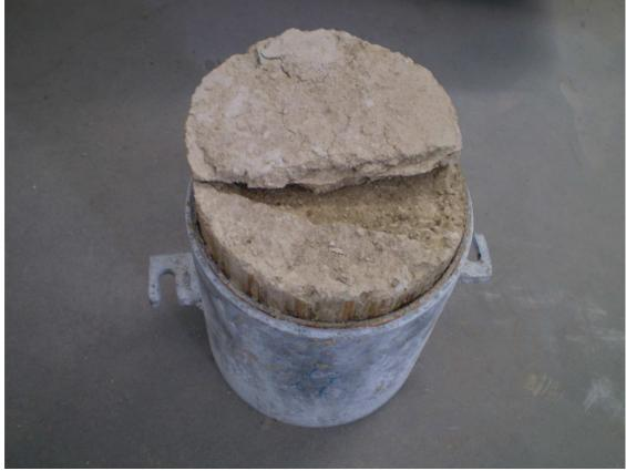
Figura 156. Probeta de S1E5 tras el ensayo de expansión potencial
