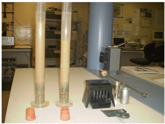
Figura 182. Ensayo de equivalente de arena de las mezclas para firmes
