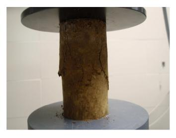
Figura 146. Probeta de mezcla con escoria S3E5 con 90 días de curado
