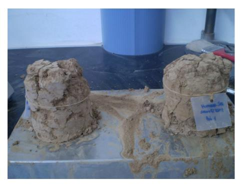
Figura 168. Probetas tras ensayo humedad-sequedad de la mezcla S3E5
