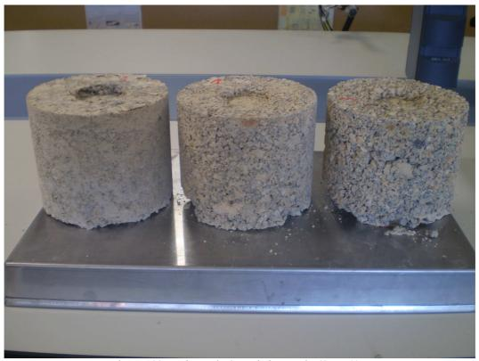
Figura 193. Probetas de CBR de la mezcla 60EN-40D
