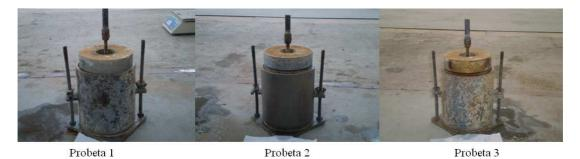
Figura 35. Hinchamiento tras ensayo de expansión potencial para la E2.
