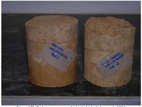
Figura 172. Probetas tras ensayo hielo-deshielo de la mezcla S3E5
