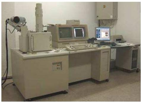
Figura 23. Microscopio electrónico de barrido
