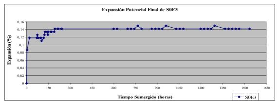
Figura 148. Expansión potencial final de la mezcla S0E3
