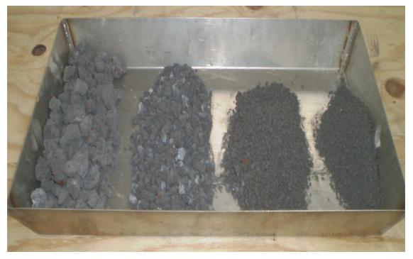
Figura 80. Diferentes fracciones granulométricas de escoria de EAF
