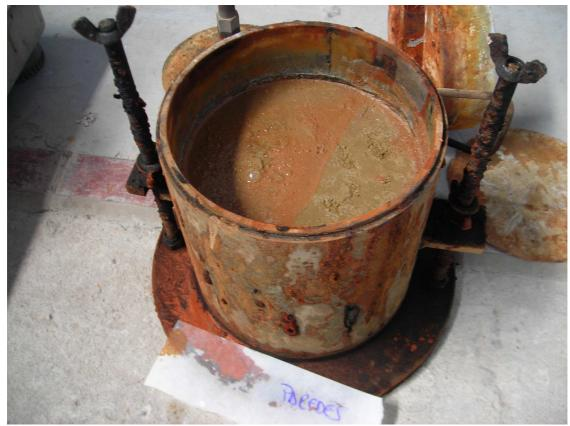
Figura 158. Probeta de S3E5 tras el ensayo de expansión potencial
