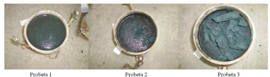
Figura 36. Aspecto del material tras ensayo de expansión potencial para la E1
