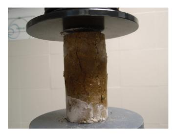
Figura 145. Probeta de mezcla con cal S3C2 con 90 días de curado
