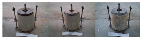
robeta 1 Probeta 2 Probeta 3 Figura 34. Hinchamiento tras ensayo de expansión potencial para la E1.
