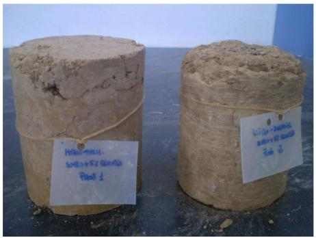
Figura 170. Probetas tras ensayo hielo-deshielo de la mezcla S1E5
