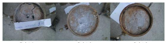
Probeta 1 Probeta 2 Probeta 3 Figura 37. Aspecto de material tras ensayo de expansión potencial para la E2.
