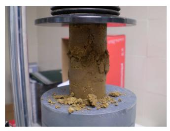
Figura 144. Probeta de suelo S3 con 90 días de curado
