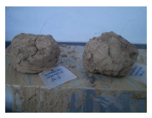
Figura 167. Probetas tras ensayo humedad-sequedad de la mezcla S3C2
