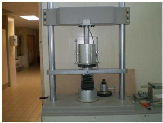
Figura 191. Prensa para pinchar las probetas CBR
