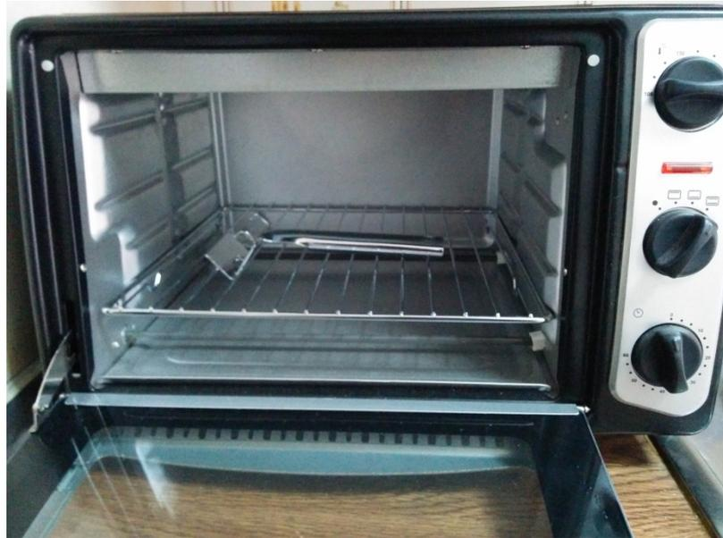
Figura 1. Horno de refusión utilizado en el prototipo
