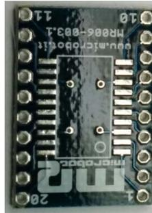
**Figura 4.** Adaptador SSOP20 a DIP
