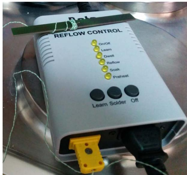
Figura 2. Regulador del horno de refusión
