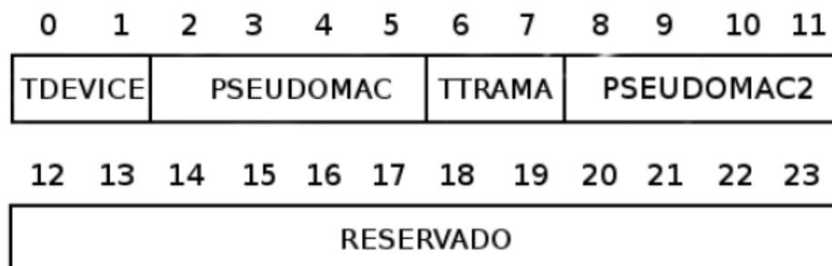
Figura 18. Trama de ACK de Master a Esclavo
