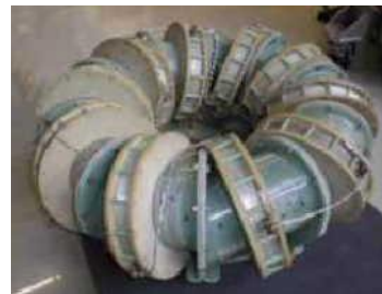
Figura 6. Representación esquemática e imagen real de una bobina para sistema SMES
