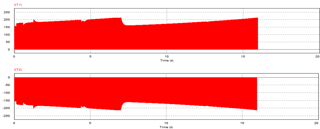
Figura 15.2. Representación de las corrientes por el IGBT I_{T1} y diodo I_{D2} = -I_{T2}
