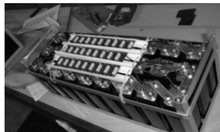
Figura 3. Banco de supercondensadores de 132 células de 2,3V en serie. Tensión total de 300V. Desequilibrio entre células corregido mediante resistencias en paralelo
