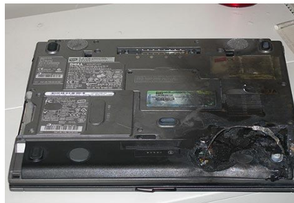
Figura 2. Incendio de la batería de litio de un ordenador portátil
