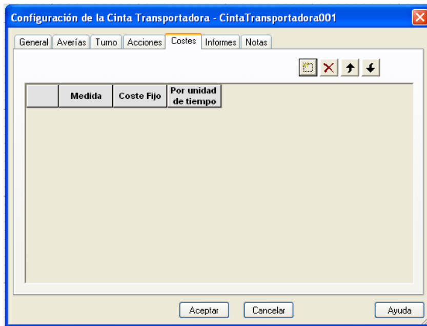
Figura 27. Ventana detalle de Witness para parametrizar las cintas transportadoras.
