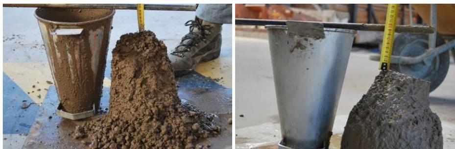
Imagen 5.1 Ensayo de asentamiento
