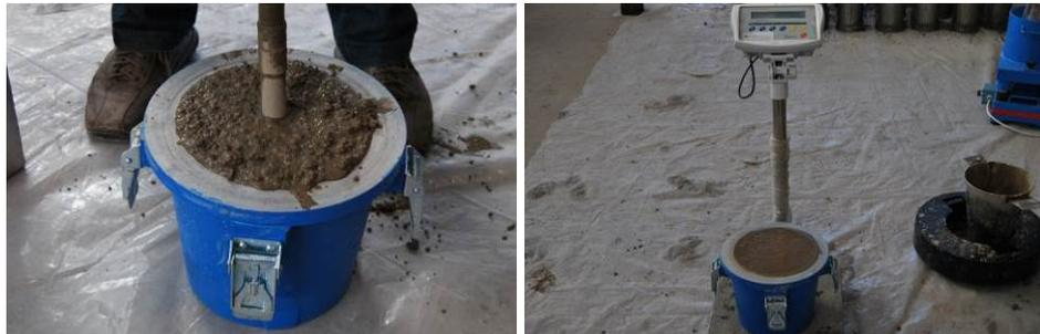
Imagen 5.4 Ensayo de densidad del hormigón fresco
