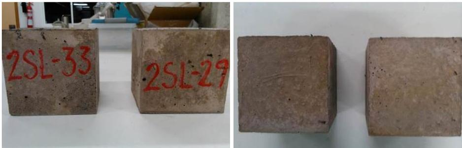
Imagen 6.21 Probetas de la dosificación SL después de los 15 ciclos de atmosfera industrial
