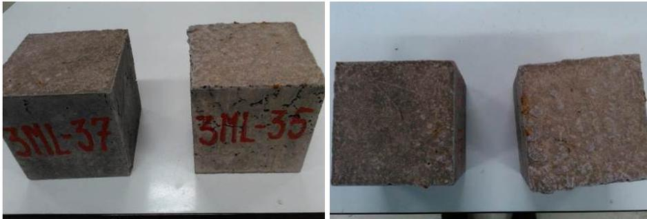
Imagen 6.20 Probetas de la dosificación ML después de los 15 ciclos de atmosfera industrial
