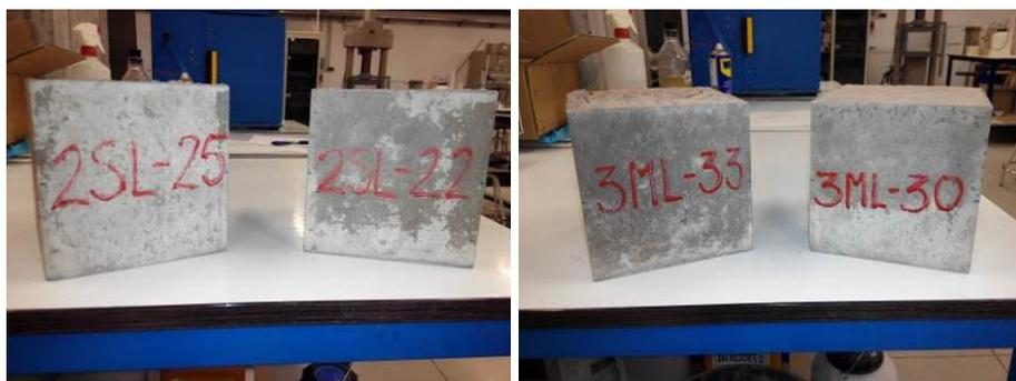
Imagen 6.14 Aspecto superficial de las probetas después de los 15 ciclos del ensayo
