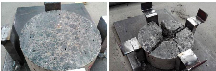
Imagen 5.22 Probeta con 1ª fisura (Izq), rotura completa (Dcha)
