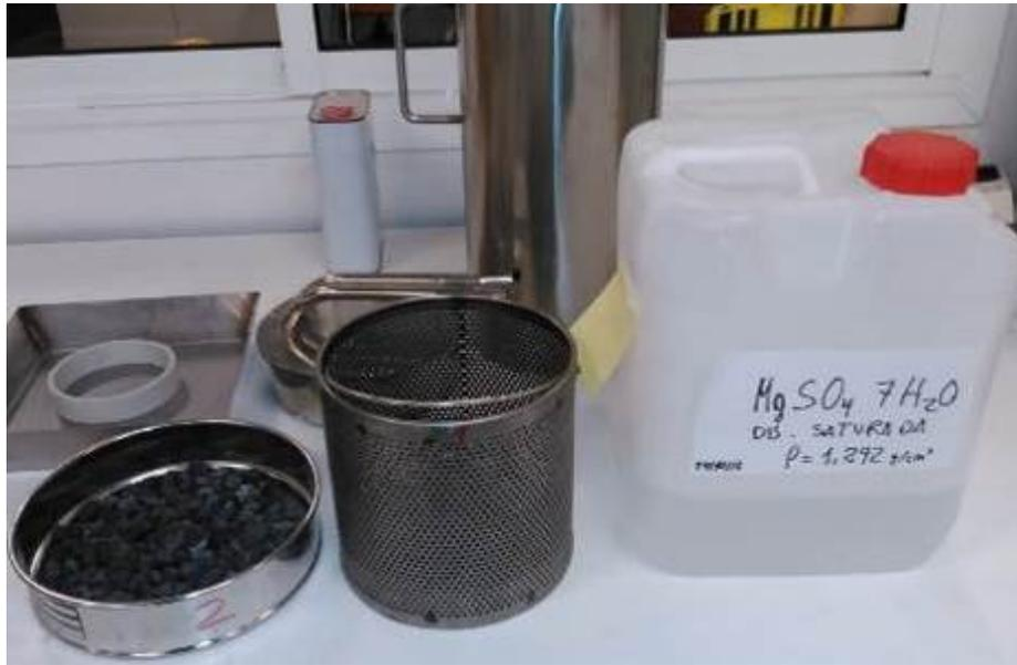
Imagen 3.5 Muestra para ensayo de sulfato de magnesio
