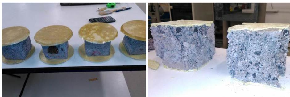
Imagen 6.10 Probetas después de los ciclos de hielo-deshielo, antes del ensayo a compresión y después
