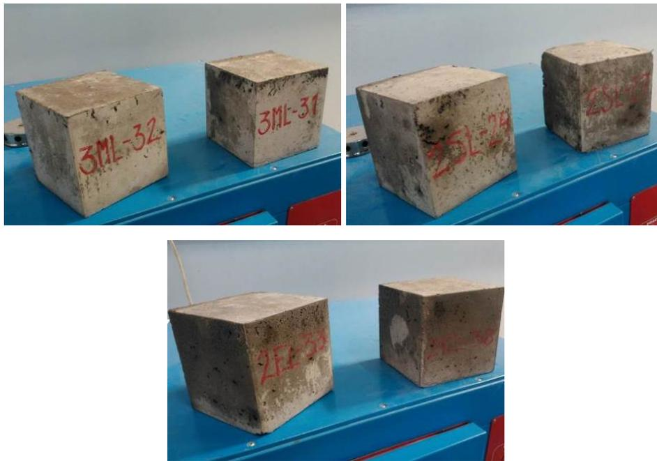
Imagen 6.11 Probetas antes del ensayo de humedad-sequedad
