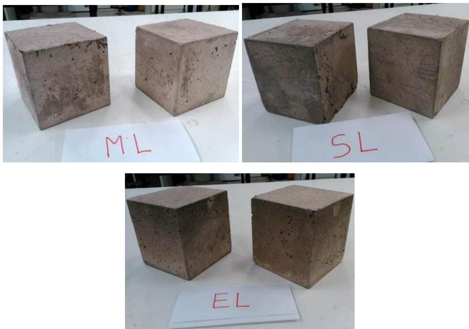
Imagen 6.12 Probetas después de los ciclos de humedad-sequedad
