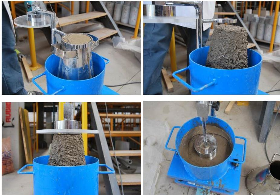
Imagen 5.3 Ensayo consistómetro Vebe
