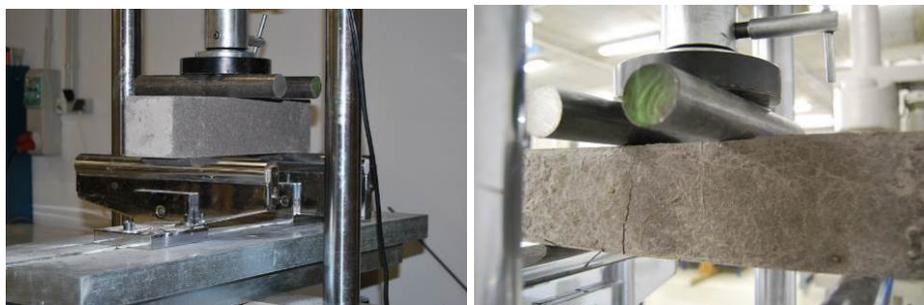
Imagen 4.8 Equipo de ensayo a flexotracción con probeta de ensayo
