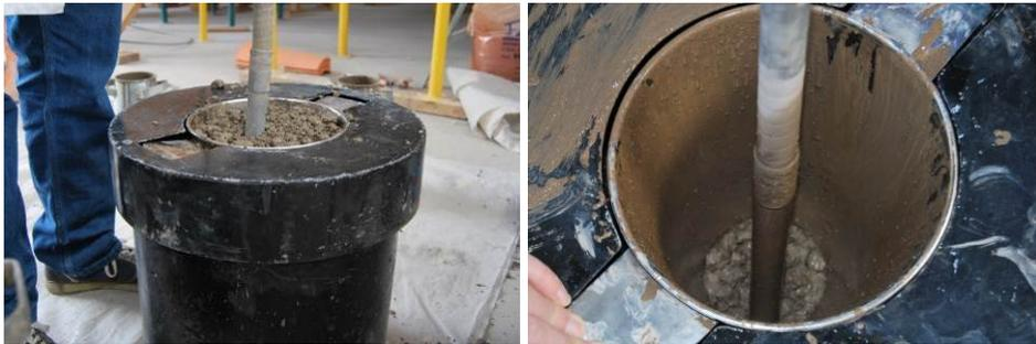
Imagen 5.2 Ensayo del Cono invertido
