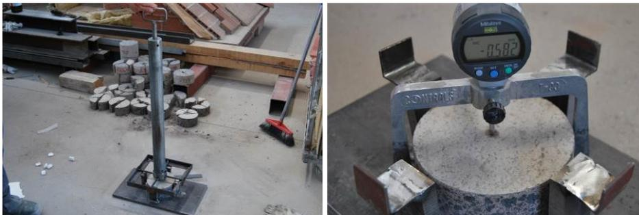
Imagen 7.14 Dispositivo para el ensayo de resistencia al impacto y para la medición del cráter de impacto
