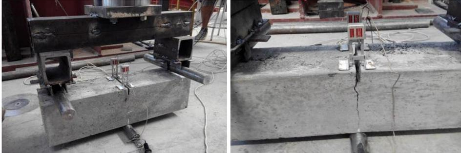
Imagen 5.19 Aspecto de la probeta en el ensayo LOP al inicio del ensayo y con la fisura producida
