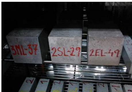
Imagen 6.19 Probetas en el ensayo de atmosferas industriales (Kesternich)
