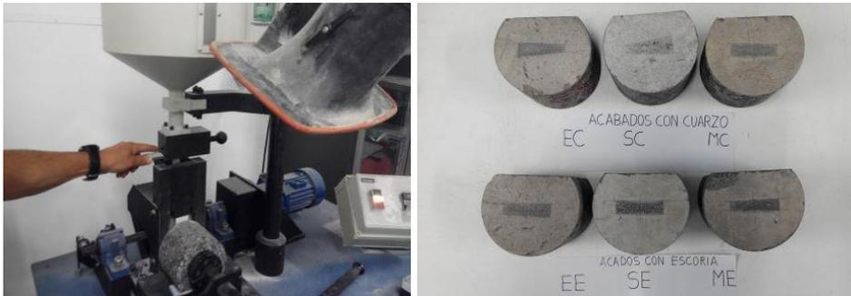
Imagen 7.16 Testigo en ensayo y huellas marcadas en los acabados de los testigos ensayados
