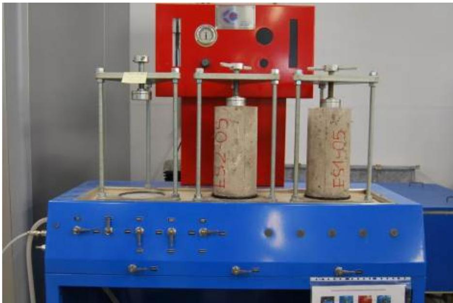
Imagen 4.11 Equipo de ensayo de penetración de agua a presión
