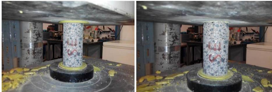
Imagen 7.13 Testigo antes y después del ensayo a compresión
