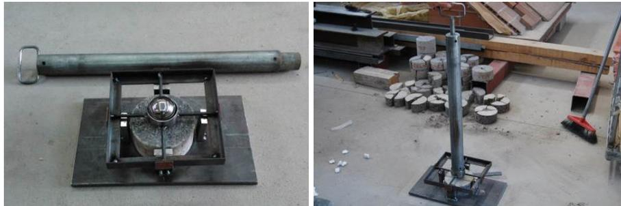
Imagen 5.21 Dispositivo soporte, bola de acero, maza y disposición del ensayo al impacto
