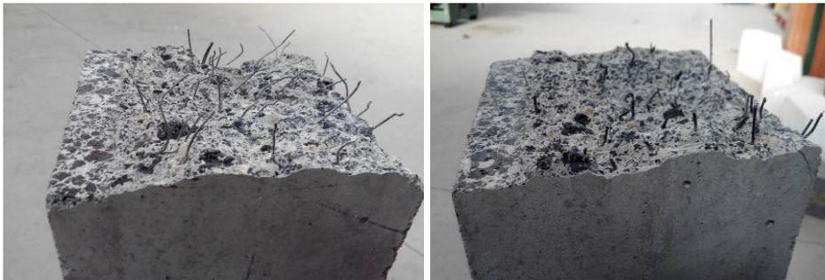
Imagen 5.20 Aspecto de la distribución de las fibras metálicas (Izq) y sintéticas (Dcha) en probetas ensayadas de resistencia a tracción por flexión (LOP)
