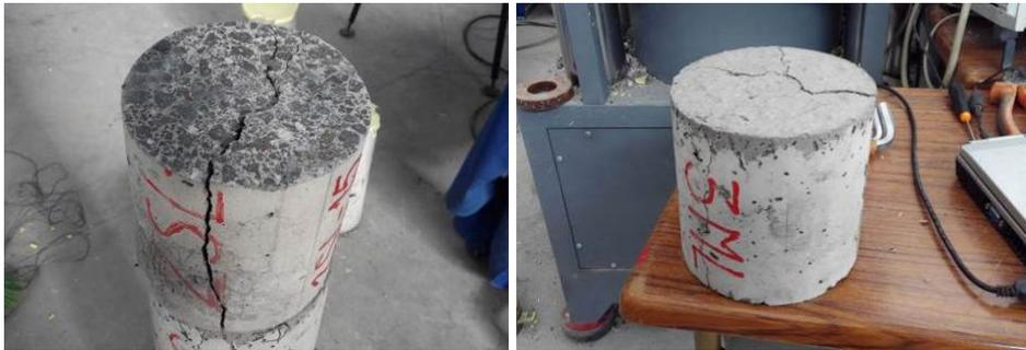
Imagen 5.17 Grietas radiales en probetas después del ensayo método Barcelona
