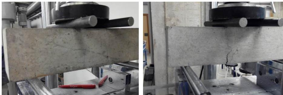
Imagen 5.15 Probetas en la primera fisura, y al finalizar el ensayo
