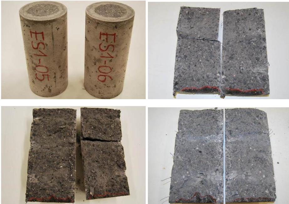
Imagen 4.12 Probetas antes y después del ensayo de penetración de agua a presión
