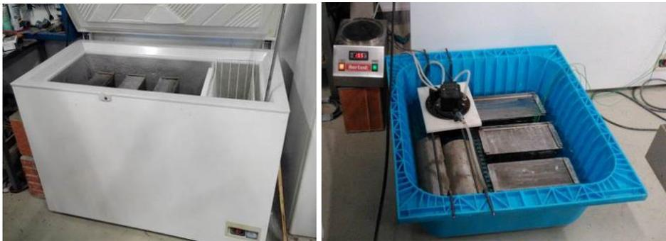
Imagen 6.2 Congelador y dispositivo de deshielo con circulación de agua
