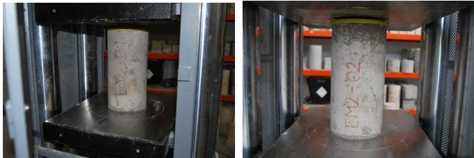
Imagen 4.7 Probetas preparadas para ensayar a compresión
