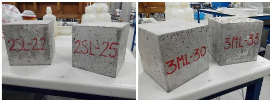
Imagen 6.13 Probetas de las amasadas SL y ML antes de ser sumergidas
