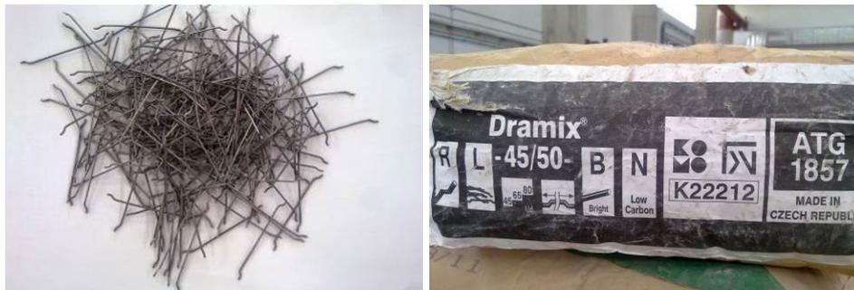
Imagen 3.21 Aspecto de las fibras metálicas Dramix RC-45/50-BN y de su etiquetado
