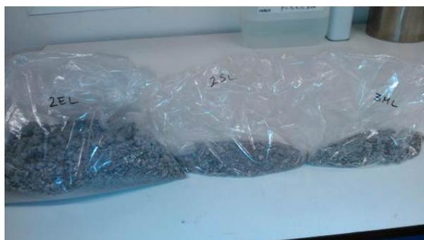
Imagen 6.8 Cantidad de masa perdida por dosificaciones tras el ensayo de hielo-deshielo
