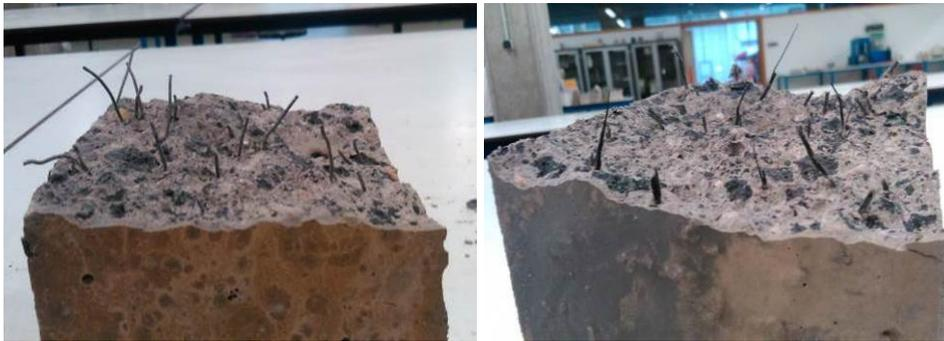
Imagen 6.16 Aspecto de las probetas partidas antes de aplicarlas la disolución de fenolftaleína
