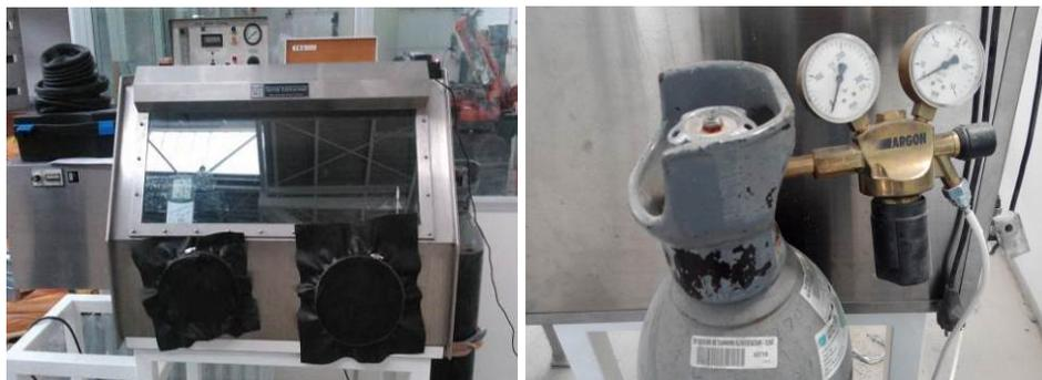
Imagen 6.15 Cámara estanca y botella de  $\text{CO}_2$  con el instrumental de llenado
