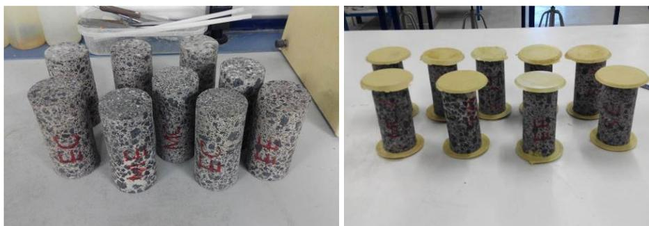
Imagen 7.12 Testigos para la resistencia a compresión antes y después del refrentado.
