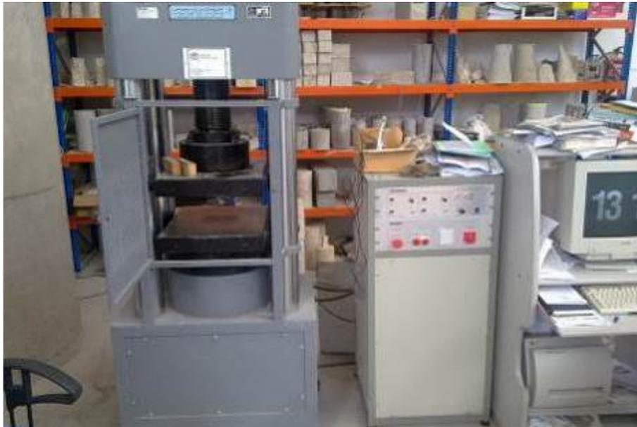
Imagen 4.6 Equipo utilizado para la determinación de resistencia a compresión
