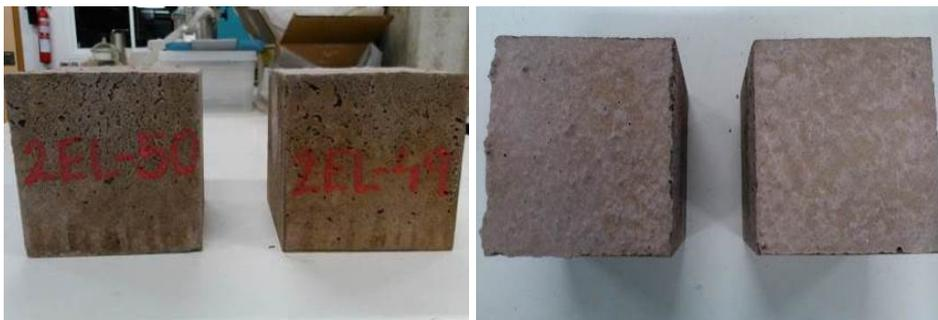
Imagen 6.22 Probetas de la dosificación EL después de los 15 ciclos de atmosfera industrial
