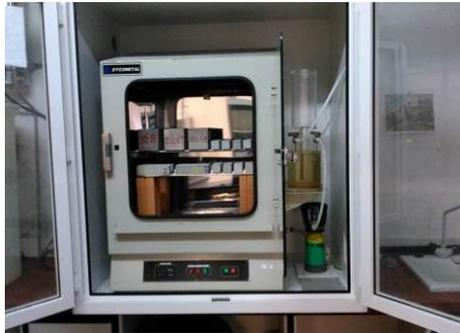
Imagen 6.18 Cámara para el ensayo de atmosferas industriales (Kesternich)
