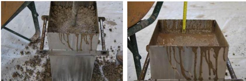
Imagen 5.5 Ensayo de grado de compactibilidad
