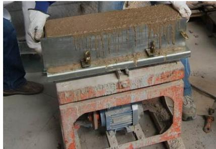
Imagen 4.5 Mesa vibrante para el compactado de probetas
