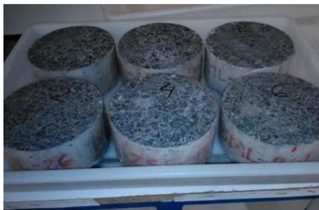
Imagen 5.12 Probetas en el ensayo de absorción de agua por capilaridad
