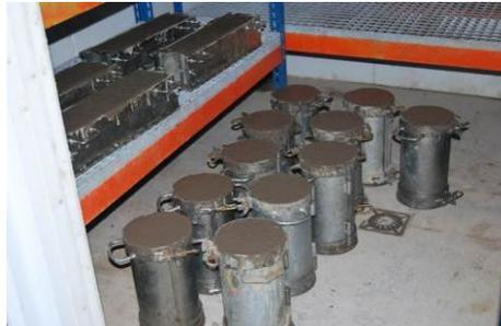
Imagen 4.4 Probetas cilíndricas y prismáticas
