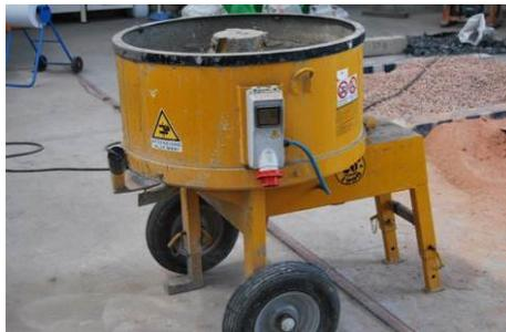
Imagen 4.1 Hormigonera de eje vertical de 120 litros
