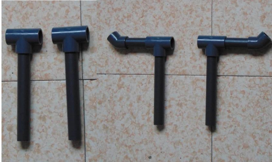
Figura 2: Unión de los tubos de PVC de 19,5 cm con las “T”. Unión de los tubos PVC de 9,5 cm a las “T” Fuente: elaboración propia.
