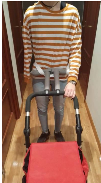
Figura 3: Producto final anclado a la cadera y el carro. Fuente: Elaboración propia.
