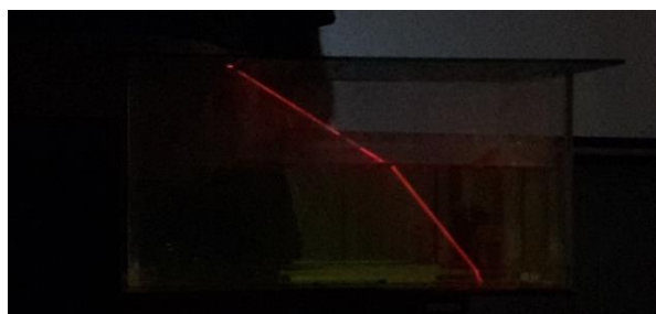
Ilustración de Anexos 69 - Refracción de un haz de luz. (Fuente: Elaboración propia)
