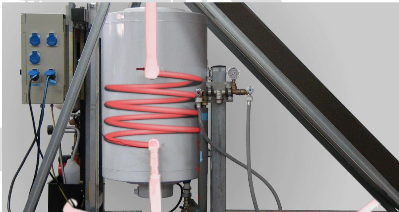
El sistema de acumulación es el encargado de almacenar el calor transferido desde los captadores térmicos a través del intercambiador.
