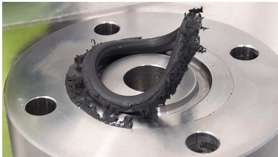
Figura 30 junta tórica de FKM (fluorocarbono) degradada después de trabajar con CO 2 (Hiperbaric 2021)
