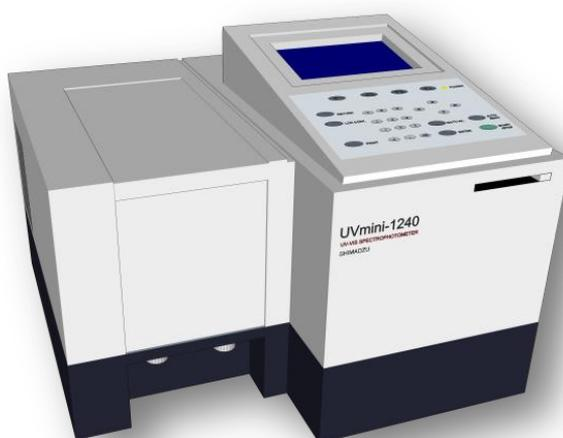
**Figura 159. Espectrofotómetro UV-Vis Shimadzu UVmini-1240.**
