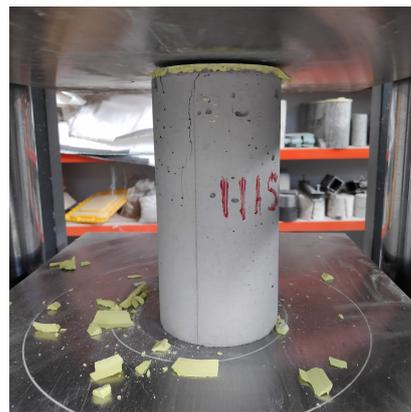
(b) Cylinder:  $\phi$ 100 x 200 mm
