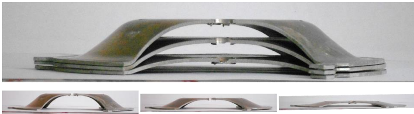
Figura 5.9. Detalle de las probetas de ancho 80mm tras ser embutidas a las diferentes profundidades fijadas en el DOE.
