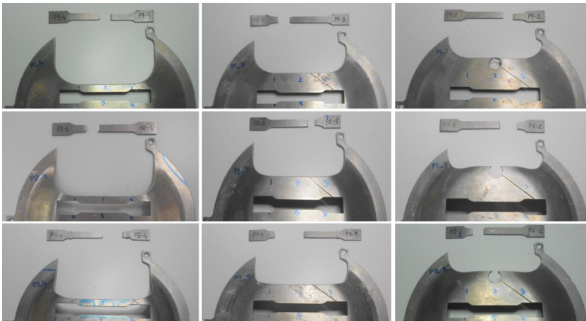
Figura 5.21. Detalle de algunas de las probetas Marciniak, con sus correspondientes probetas de tracción ya ensayadas.
