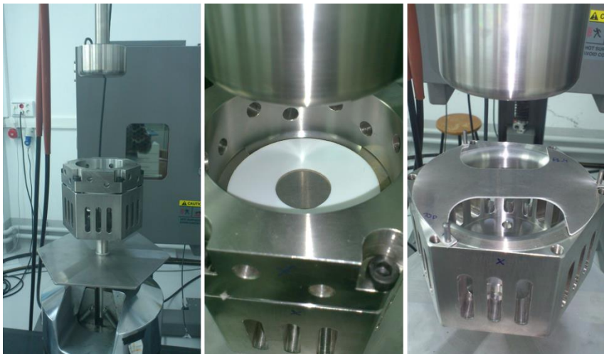
Figura 3.16. Montaje del sistema de ensayos para el ensayo Marciniak.
