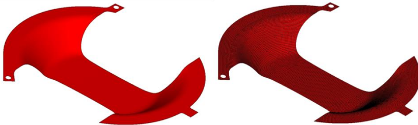
Figura 5.60. Ejemplo de geometría de entrada para HyperForm, deformada proveniente de las simulaciones de embutición de ABAQUS para el ancho 40mm y profundidad 18mm.
