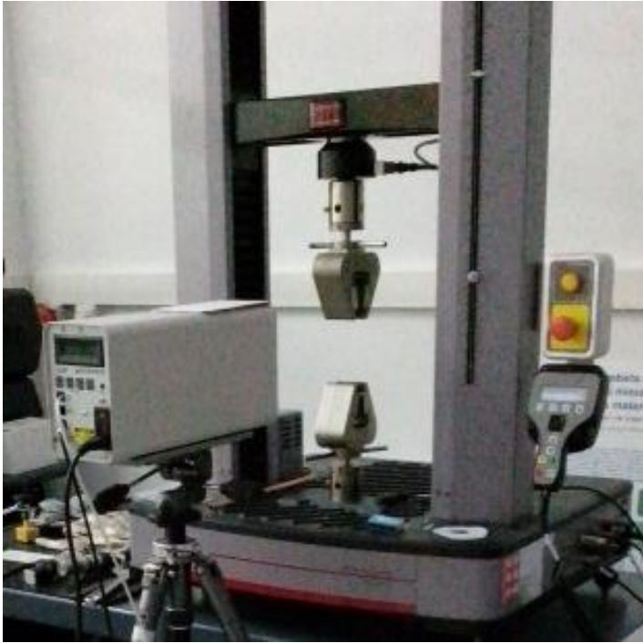
Figura 3.3. Montaje del sistema de ensayos de tracción uniaxial.
