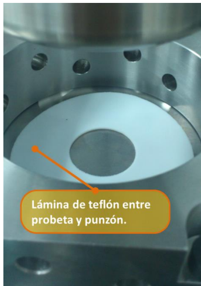
Figura 5.8. Lámina de teflón para evitar contacto directo punzón-probeta.
