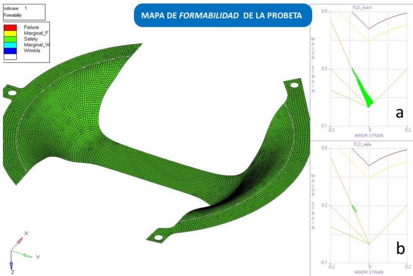
Figura 5.64. Resultados de formabilidad para la probeta 5. a) Probeta completa b) Rejilla central de control.
