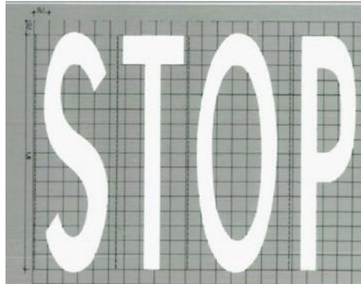
Ilustración 10: Dimensiones de la señal horizontal "STOP"
