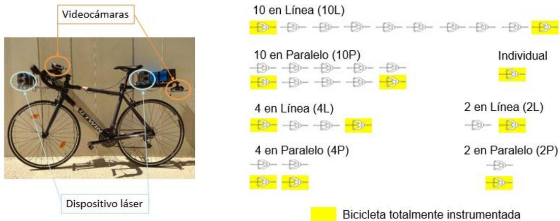
**Fig. 2 - Bicicleta instrumentada y configuraciones estudiadas.**
