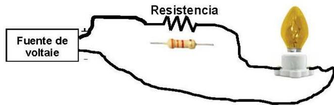
6. Los circuitos eléctricos integrados por resistencias, se pueden conectar de las siguientes formas:
