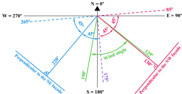
Fig. 4. Wind load angles on the façades.
