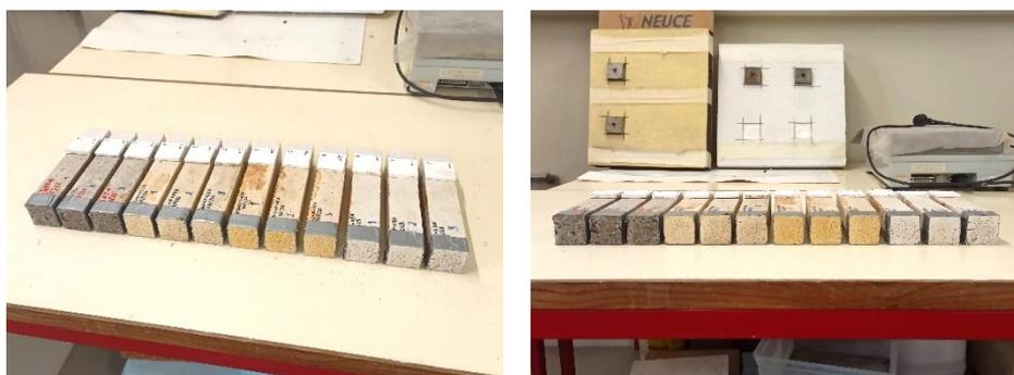
Figura 4.4. Estado final de las probetas de las dosificaciones analizadas en la fase de caracterización de las mezclas tras el ensayo de absorción de agua por capilaridad
