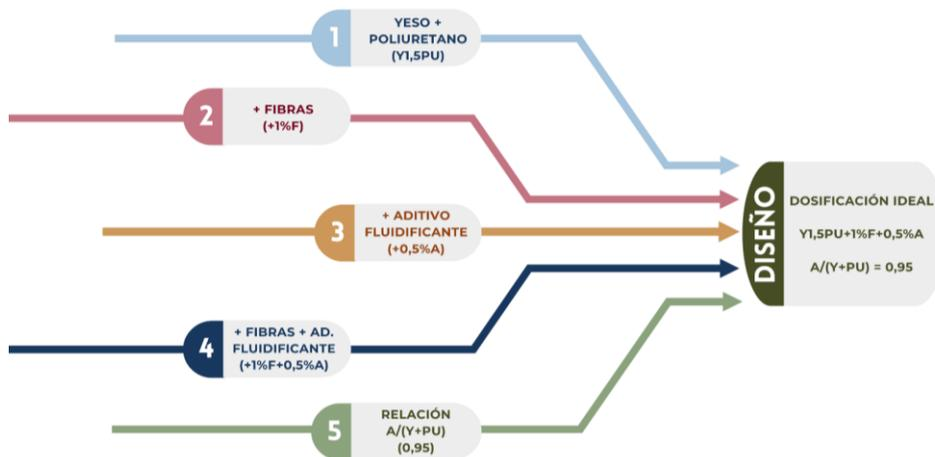
Figura 3.12. Resumen de las conclusiones de la fase de diseño de la dosificación idónea
