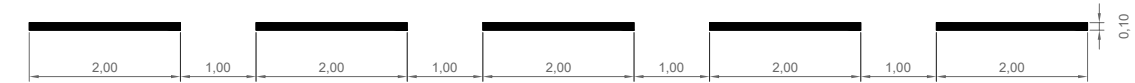
M-1.10 VIAS CON V. <60 KM/H PARA PREAVISO DE MARCA CONTINUA O DE PELIGRO
