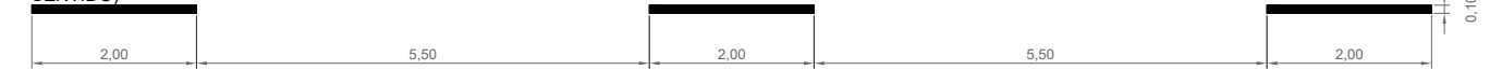
M-1.3 VIAS CON V. <60 KM/H PARA SEPARACION DE CARRILES NORMALES (DIFERENTE SENTIDO)
