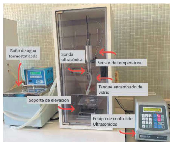
Figura 4. Fotografía del equipo empleado en los experimentos de extracción asistida con ultrasonidos.
