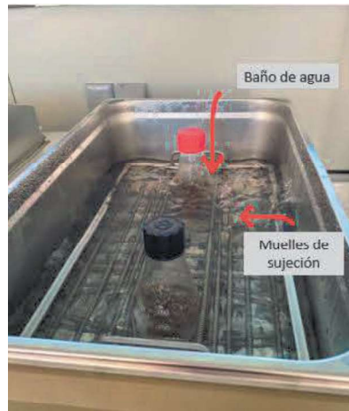
Figura 3. Fotografía del equipo utilizado en los experimentos de extracción convencional en baño agitado.
