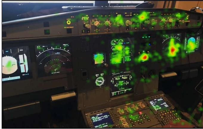
Figura 3.12: Representación del uso del *eye tracking* en una cabina real de un avión [Aerospace, 2024]
