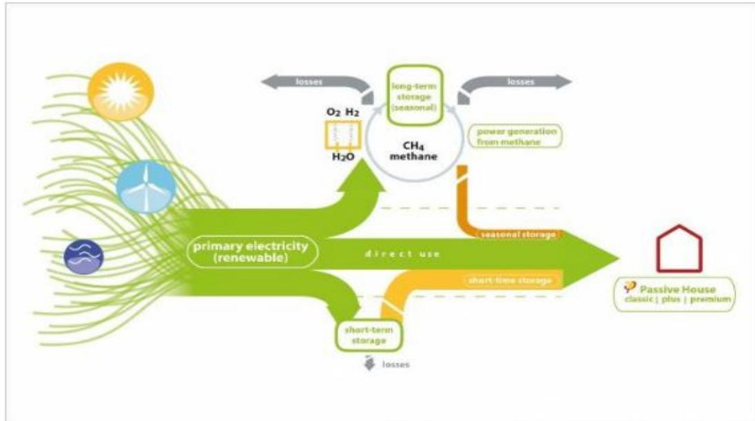
Figura 10. Esquema de la demanda global de energía primaria renovable (PER)
