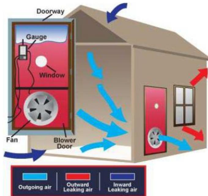
Figura 13. Esquema del Blower Door test
