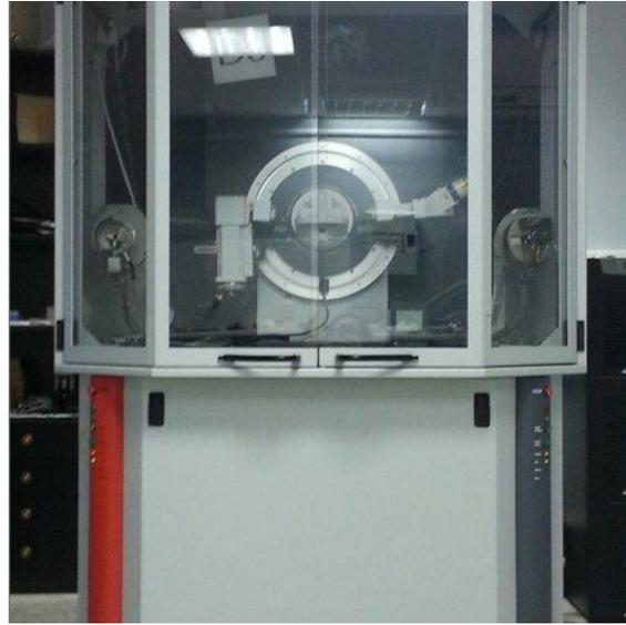
Figura 4.2. DRX utilizado en la caracterización
