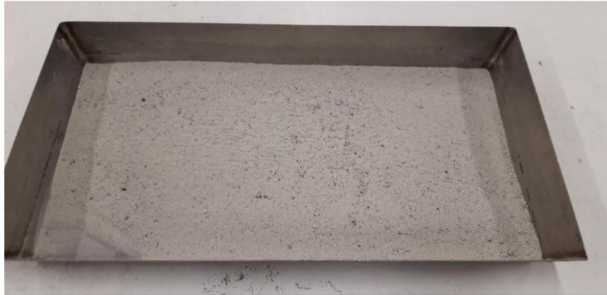
Figura 5.3. Aspecto final de las escorias después de su acondicionamiento
