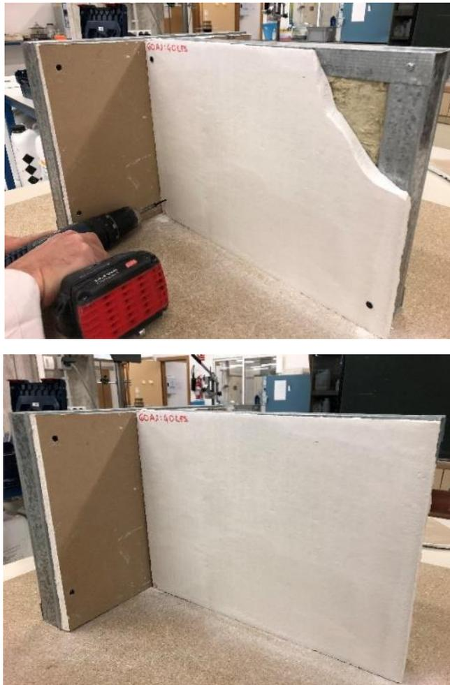
Figura 7.9. Colocación placa prefabricada PL60S
