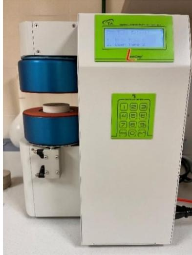
Figura 6.5. Ensayo de conductividad térmica
