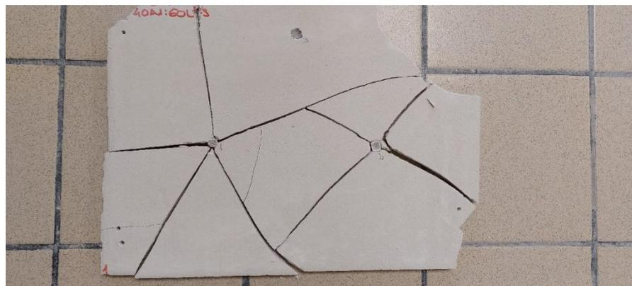
Figura 6.3. Resistencia al impacto en placas de escayola
