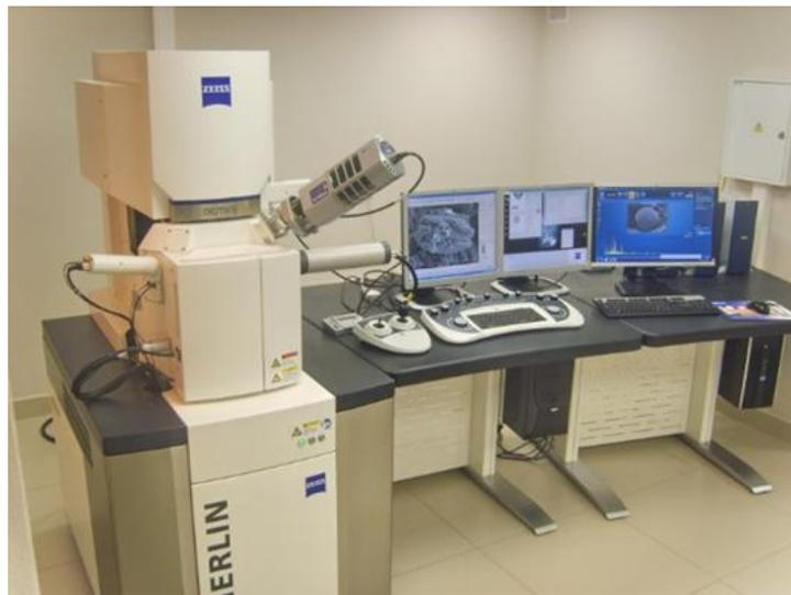
Figura 4.3. FESEM para determinar la microestructura
