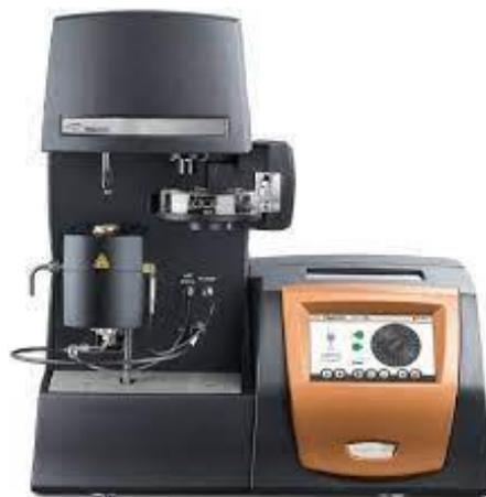
Figura 4.4. Termogravimetría (TGA)
