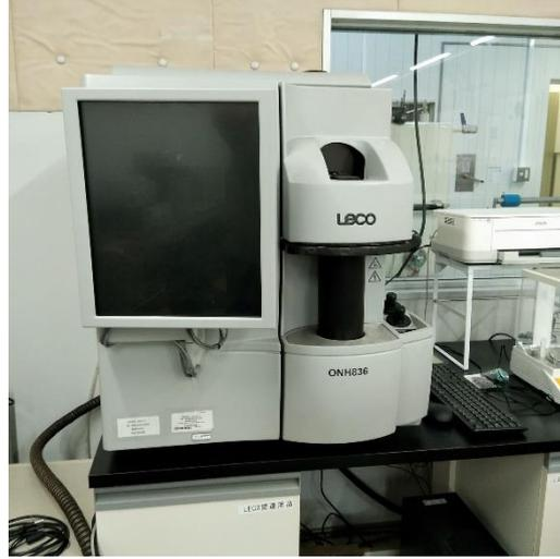
Figura 4.1. Analizador elemental LECO
