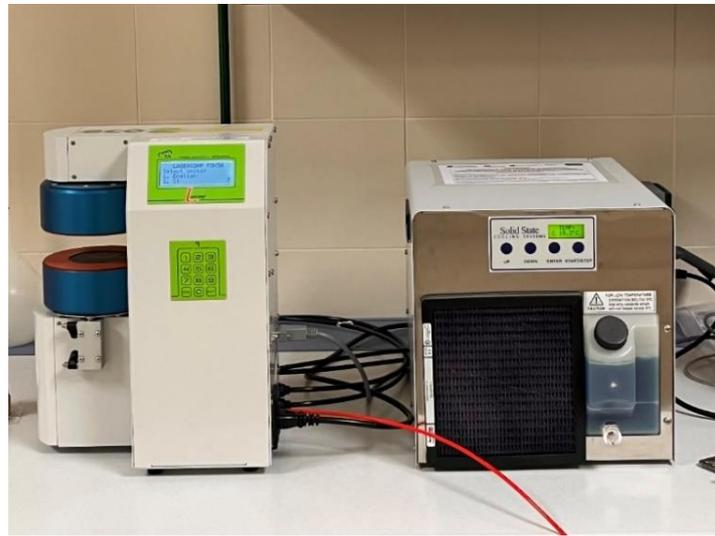
Figura 4.11. Ensayo de conductividad térmica
