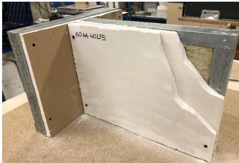
Figura 7.10. Colocación placa prefabricada PL40S
