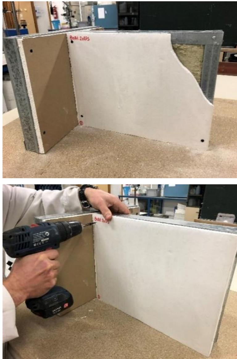
Figura 7.7. Colocación placa prefabricada PL20S
