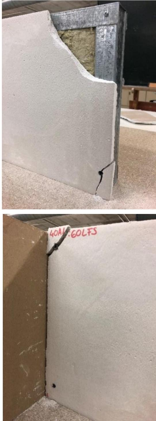
Figura 7.12. Rotura placa prefabricada PL60S
