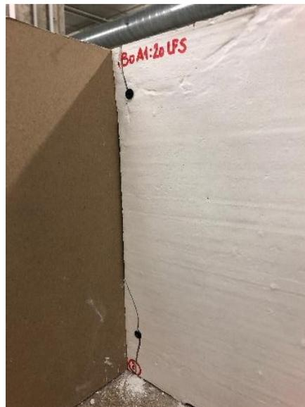
Figura 7.8. Rotura placa prefabricada PL40S
