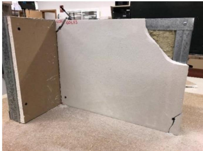
Figura 7.11. Rotura placa prefabricada PL60S
