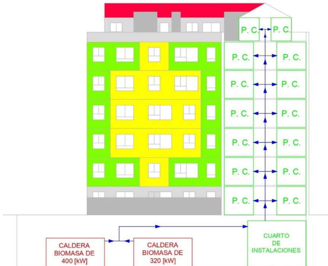
*Ilustración 1.* Instalación del bloque con dos calderas de biomasa proporcionando potencias similares.
