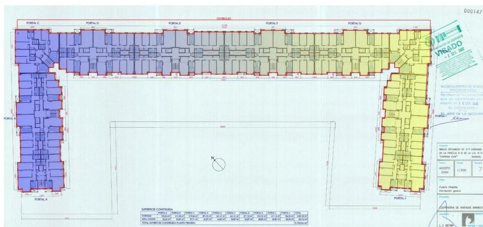
Figura 4: Muestra de modo de cálculo de superficie útil habitable mediante AutoCAD. El plano visible ha sido obtenido de los documentos propiedad del Ayuntamiento de Burgos, en él, se reflejan las dimensiones de la primera planta del bloque.
