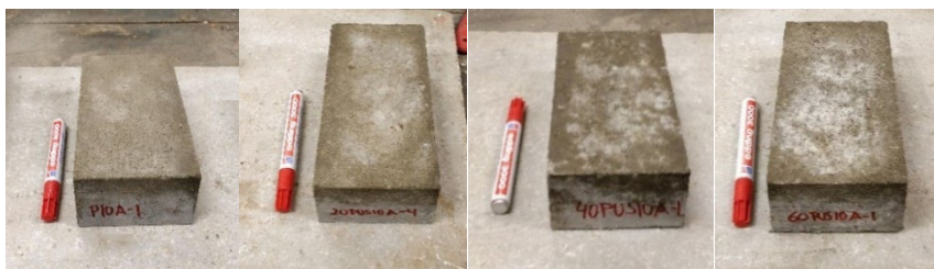
Figura 6.4 Aspecto visual adoquines; REF (izq.); 20 % (centro-izq.); 40% (centro-dcha.); 60 % (dcha.)
