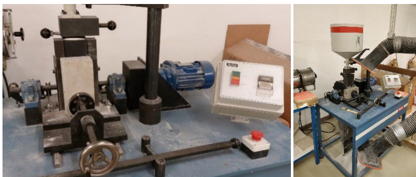
Figura 4.4 Ensayo de desgaste por abrasión mediante equipo de Disco Ancho
