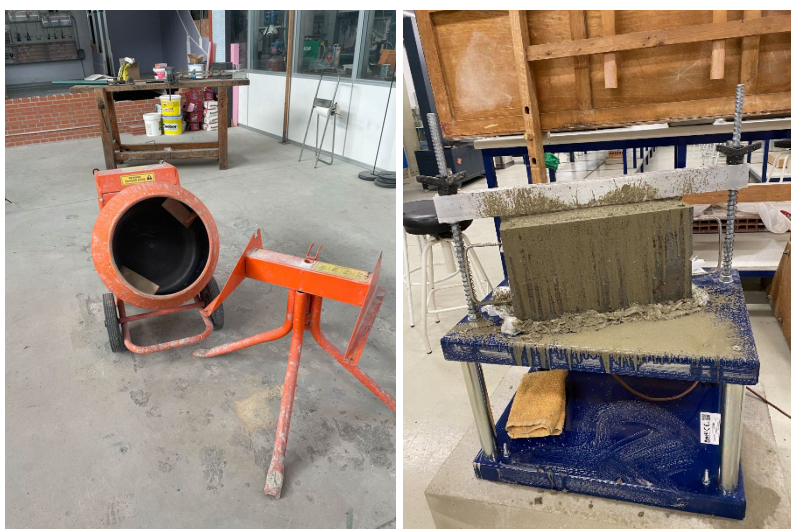
Figura 7.1 Proceso de mezclado y vibrado de los bloques
