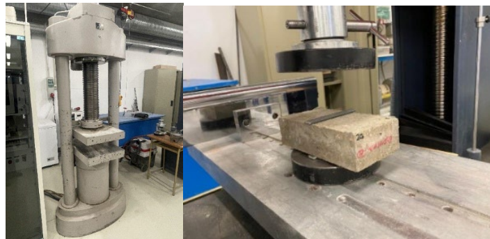
Figura 4.3 Ensayo rotura a compresión en prensa normalizada a. Vista general de la prensa normalizada en el ensayo de bloque refrentado. b. Adoquín dispuesto para el ensayo
