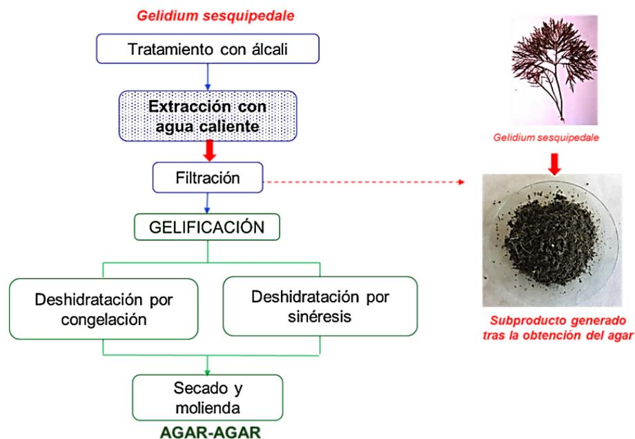
Figura 4: Diagrama de flujo dónde se puede observar la etapa en la que se genera el subproducto de la obtención del agar-agar
