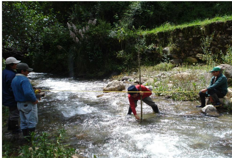
Sabiendo que el ancho del río es de 3.5 metros de ancho procedemos a calcular la profundidad o altura del río cada medio metro desde una orilla a otra, y calcularemos la altura media.
