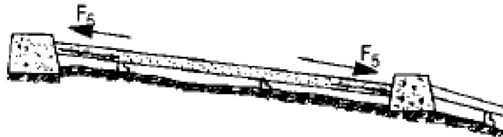
**f) Fuerza de fricción en la junta de dilatación (F<sub>6</sub>)**
