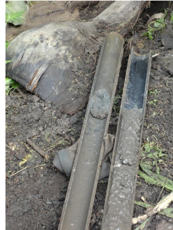
Figura 10: Detalle extracción de la muestra (fuente archivo propio)
