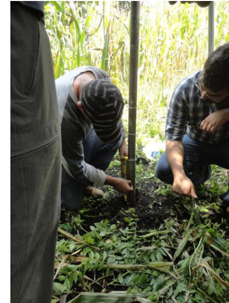
Figura 7: Rotulado de la barra para anotar la profundidad (fuente archivo propio)
