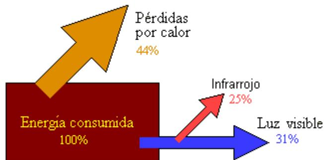
Balance energético de lámpara de vapor de sodio a baja presión.
