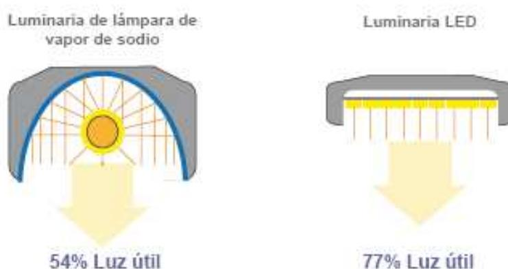
Una luminaria con lámpara de vapor de sodio de 6500 lúmenes, proporciona 3500 lúmenes de emisión de luz útil, directamente aprovechable para iluminación mientras que una luminaria LED de 5800 lúmenes proporciona 4400 lúmenes de emisión de luz útil que reierten en más lux sobre la superficie a iluminar.
