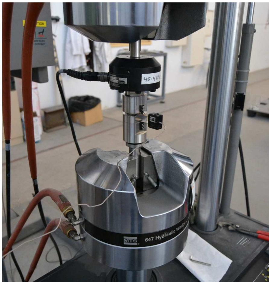
Figura 4.7. Montaje final del utillaje del SPT sobre la máquina de ensayo.
