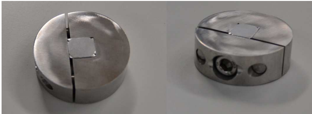
Figura 4.4. Dispositivo de sujeción para probetas miniatura.
