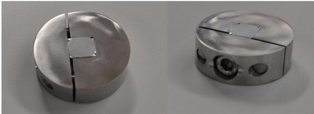
**Figura 4.7.** *Dispositivo de sujeción para probetas miniatura.*
