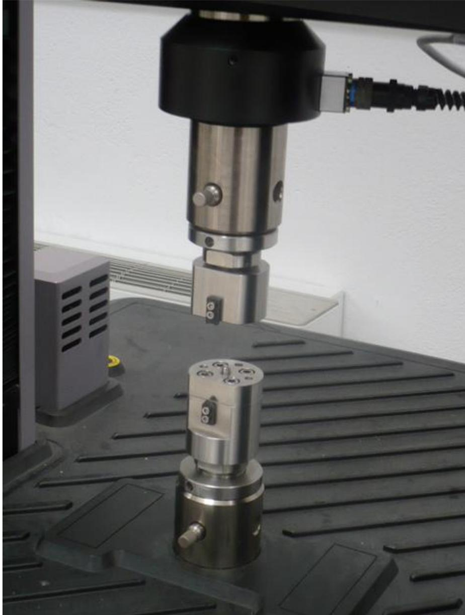
**Figura 4.10.** Montaje final del utillaje del SPT sobre la máquina de ensayo.
