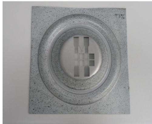
**Figura 4.5.** *Vista inferior probeta después del ensayo Marciniak.*
