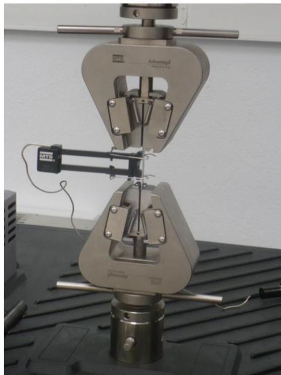
**Figura 4.6.** *Ensayo de tracción con la máquina MTS-Criterion Model 43.*
