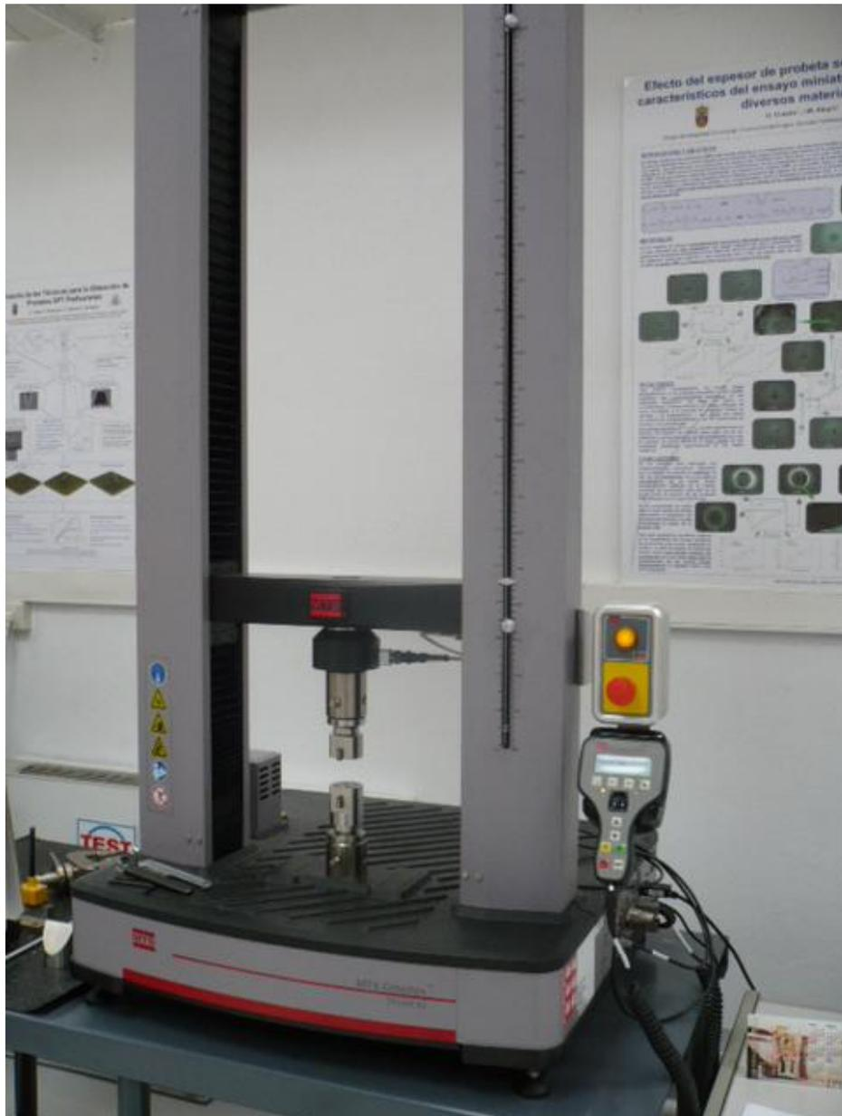
**Figura 4.1.** Máquina universal de ensayos MTS Criterion Model 43.
