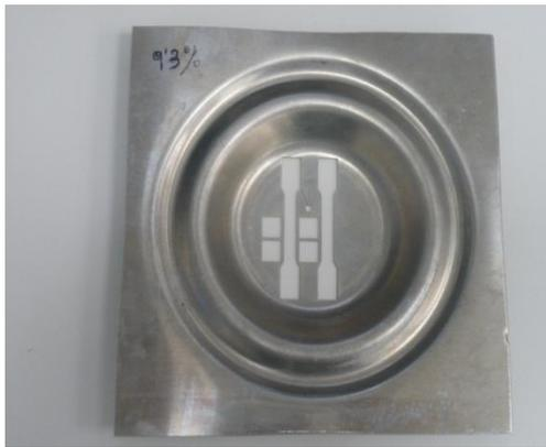
**Figura 4.4.** *Vista superior probeta después del ensayo Marciniak.*
