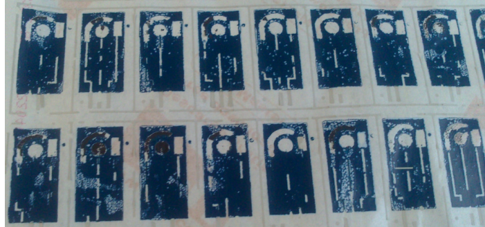
Figura 17.- Electrodo serigrafiados en papel de etiquetas.
