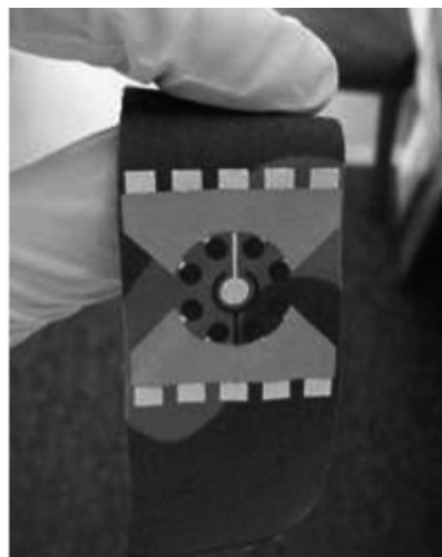
Figura 5.- Sensor electroquímico en Gore-TEX.
