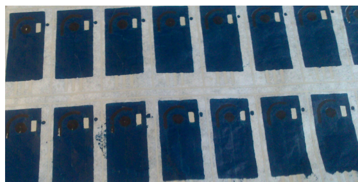
Figura 12.- Electrodo en papel separador de transparencias.
