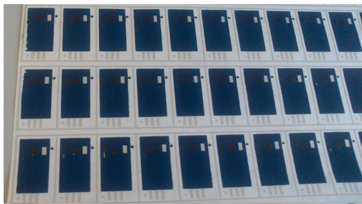
Figura 10.- Electrodo serigrafiados en papel de intercalar PET de 18 \mu\text{m} .
