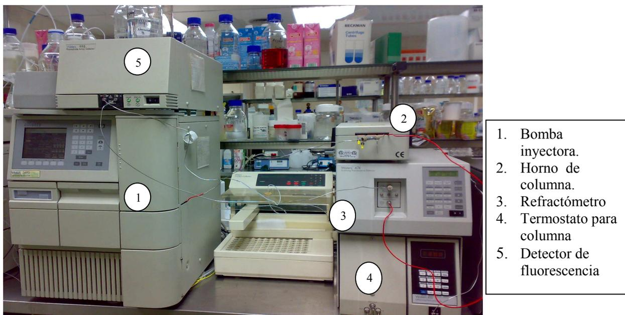
*Figura 6. Foto del equipo HPLC.*
