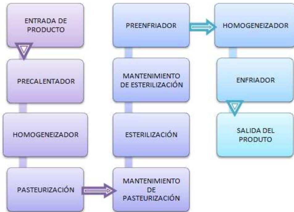
Figura 7. Diagrama de flujo de la planta piloto
