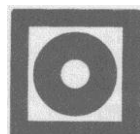
PULSADOR DE ALARMA
