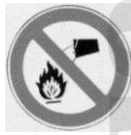
EN CASO DE INCENDIO AQUÍ NO USAR AGUA COMO MEDIO DE EXTINCION
